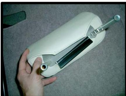
③ヘッドレストをシート本体から取り外して、底面の形を整えます。
