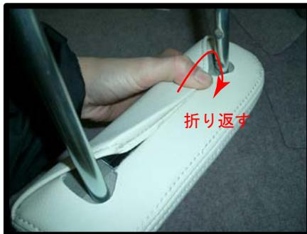
④平らなプラスチックの付いた部分を内側へ巻き込むように折り返して、フック状のプラスチックの溝に押し込んでいきます。
