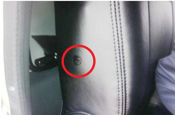
4 ランバーサポートが付いている場合は、背もたれ横にランバーサポート用のレバーがありますので、カバーをかぶせた状態でレバー軸部分に目印を付けておきます。
