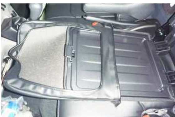
8 シートカバーをかぶせていきます。
