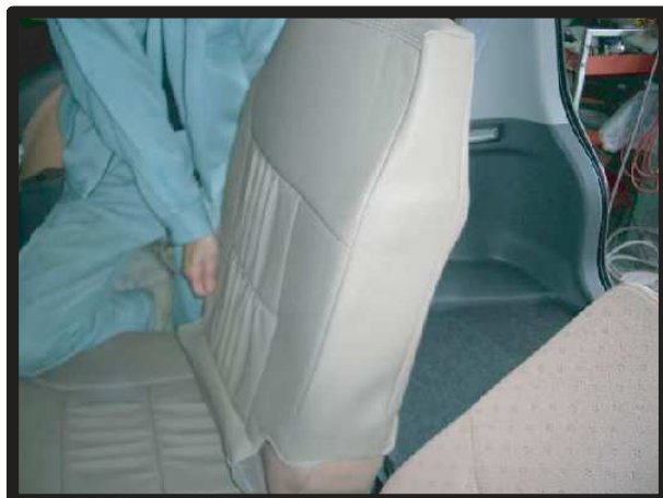
④背もたれカバーを1列目と同様にかぶせます。マジックテープの付いた部分を座面と背もたれの間に入れ込みます。
