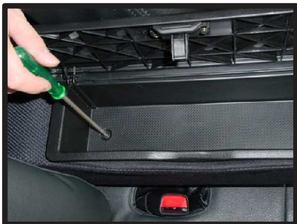
① プラスドライバーを使用し中ふたを取り外します。
