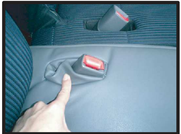
⑯シートベルトの留め具が出ている隙間に生地を入れ込みます。
