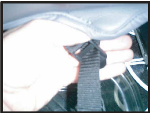
⑮カバーの前に付いてあるベルトを、シート裏から取り出します。取り出したベルトを、まずフックの真ん中に通します。
