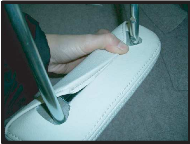
④底面をプラスチック部品で固定します。
