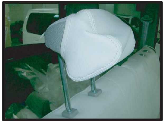
⑧2列目のヘッドレストは正面の下側からカバーをかぶせていきます。後は1列目と同様の取り付け方法で行ないます。
