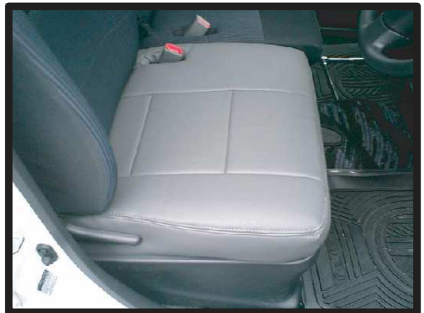
⑱シートのラインを整えて1列目座面の完成です。シートリフター付き車はシートの位置を合わせて、カバー側にシワがよる場合は、ヘラ等でシワ部分の生地を下に入れ込み調整して下さい。
