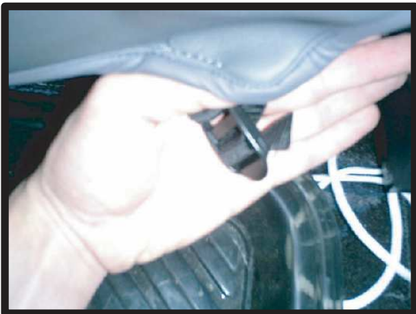
⑰次にフックの下を通します。この状態でベルトを引くと、カバーの前後が引っ張り合い固定されます。ベルトは強く引き過ぎると生地が破れる恐れがありますのでご注意ください。
