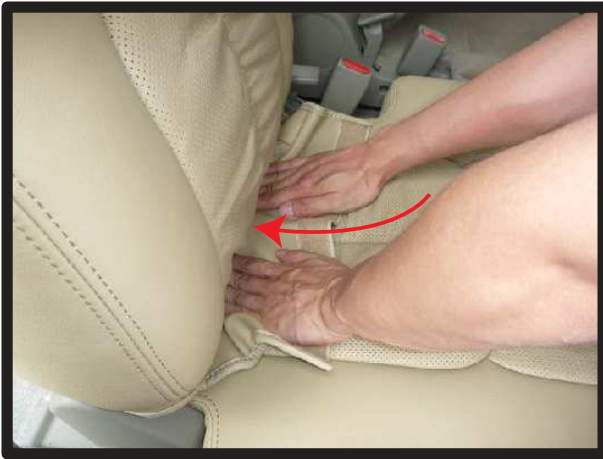
⑦座面と背もたれの隙間に生地を入れ込みます。
