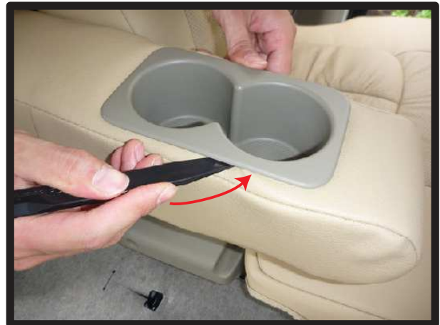
⑧はみ出している生地はヘラなどを使用してプラスチックの下隙間に入れ込みます。
