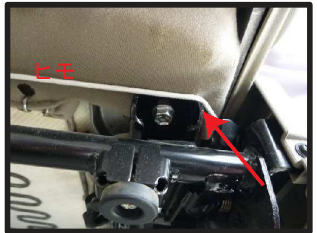
⑨背面に回した側面のヒモは必ず←部分の上を通して下さい。
