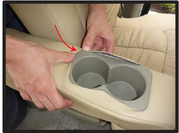
⑦2列目アームレストも形状は異なりますが、同様の固定方法で取り付けます。カップホルダーの部分は最初に四隅に生地を入れ込みます。
