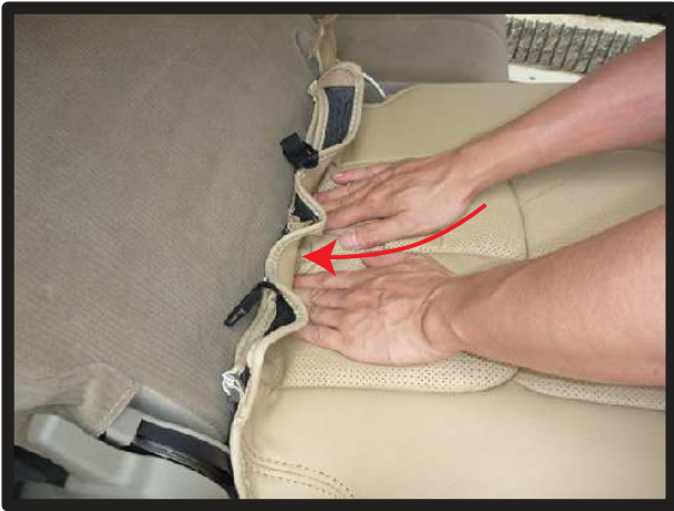
④座面と背もたれの間隙に生地を入れ込みます。
