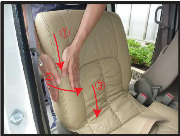
⑧図の①～③の手順で生地をなで下ろし、背もたれ中央下に寄った生地を座面と背もたれの隙間から背面に引き出します。この作業を繰り返してシートに密着させるようにカバーのシワを無くしていきます。
