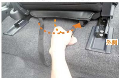
12 4番で引き出した生地に付いているベルトを、シートの裏側からシートの前側に入れ込みます。シート裏は隙間がほとんどありません。ベルトの通し方は、まずシートを一番前までスライドさせます。3本あるベルトを一旦シートの外側に寄せて、シートの底を沿わせるようにしていくと前側から引き出せるようになります。
