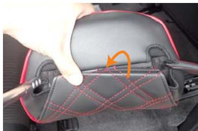
3 ヘッドレストをシートから外して、ヘッドレスト裏でプラフックを固定します。
