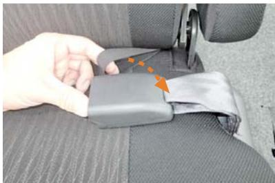
1 始めにシートベルトバックルを固定しているゴムから、シートベルトバックルを抜き出します。
