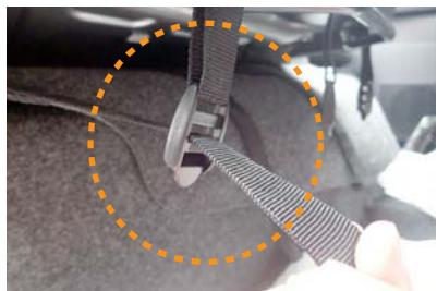
15 カバー前側に付いているバックルに引き出したベルトを通します。
