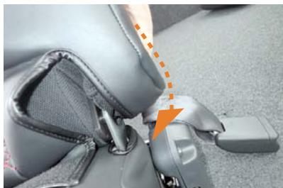
2 運転席側はシート内側の軸部分にカバーを引っ掛けるようにしてかぶせます。
