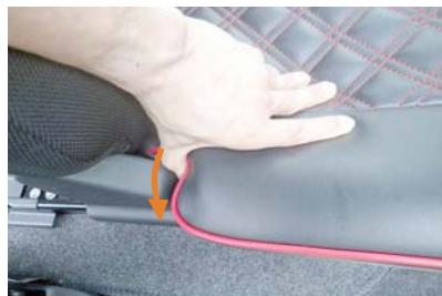
18 シート外側の付け根部分です。カバーの生地をシートに沿わせるように整えます。
