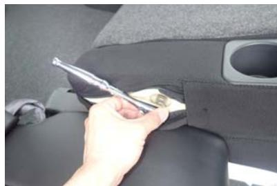
10 ソケットレンチなどを使用してアームレストを固定しているボルトを外します。ソケットは14mmを使用します。
