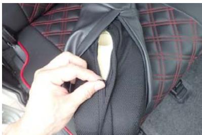
2 純正シート表皮のファスナーをボルトの固定穴付近まで閉じておきます。
