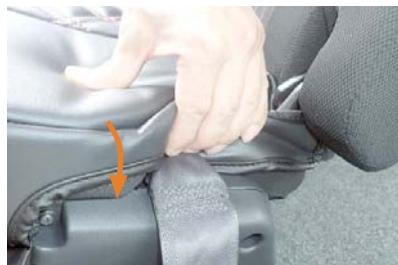
4 シート内側の軸部分です。シートベルトバックルが出ているプラスチックパーツとシートの隙間に生地を入れ込みます。
