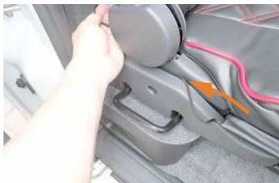
7 カバーの外側から出ているヒモを図のプラスチックパーツの隙間に入れ込みシート背面側へ通します。
