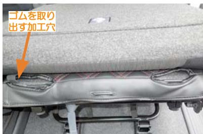
20 チャイルドシート固定用フックの位置にカバーの加工穴を合わせます。また1番で外したシートベルトバックルを固定していたゴムを、図の加工穴から取り出します
