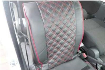
1 側面のファスナーを開いた状態で、シートのラインに合わせてカバーをかぶせます。
