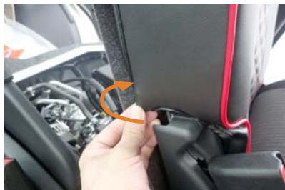
10 シート内側面後ろ側も同様に、カバーをシートの角に引っ掛けで固定します。
