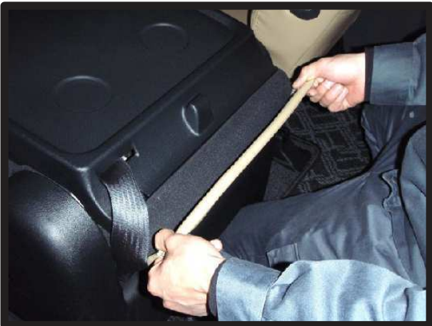
⑥入れ込んだ生地を背もたれ背面から引き出します。 引き出した生地をマジックテープでシート本体に固定します。
