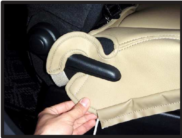
⑦リクライニングレバーをかわしてマジックテープを留めます。
