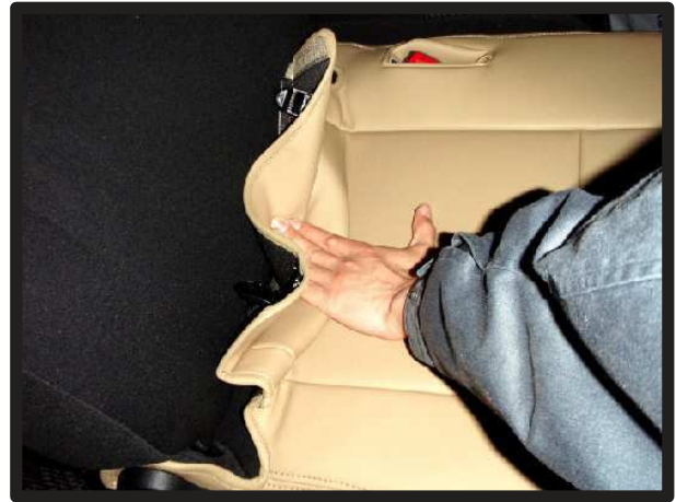
⑩背もたれと座面の隙間に生地を入れ込みます。背もたれの角度を調整して、入れ込みやすい位置で行ってください。
