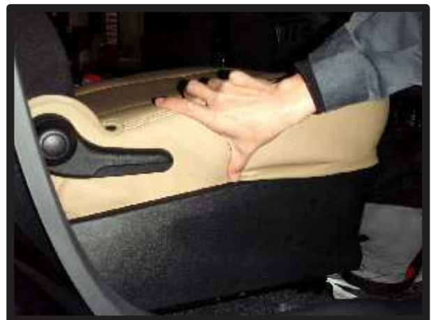
⑫シート本体とプラスチックカバーの間に生地を入れ込みます。
