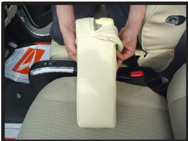
②アームレストの内側のみカバーをかぶせます。一度アームレスト全体にカバーをかぶせ、外側のみ開くと作業が行いやすくなります。
