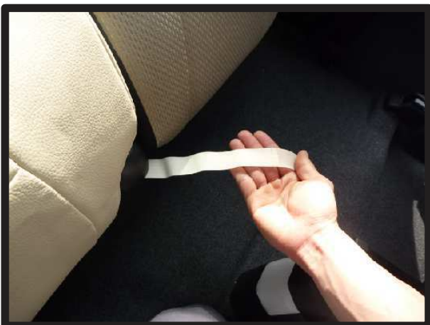
⑥スライドラバーがある位置にマジックテープのベルトが付いています。
