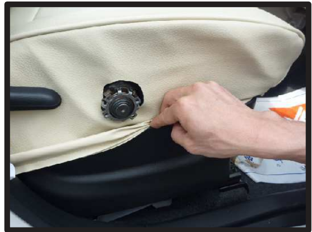
⑪シート側面の生地をプラスチック部の隙間へ入れ込みます。内側も同様に入れ込んで下さい。 ※図はシートリフター付き車です。
