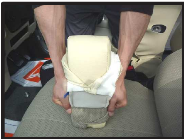
①カバーを半分ほど裏返してアームレスト先端までしっかりとかぶせます。
