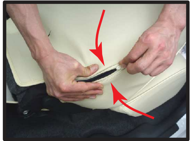
⑦図のように生地を内側へ寄せながらファスナーを閉じます。
