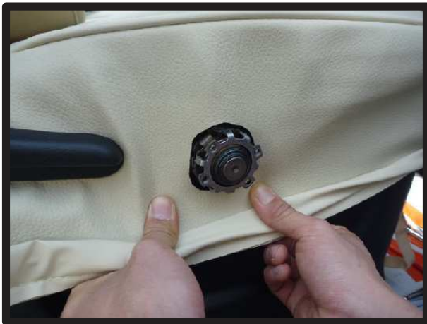
⑦シートリフターのダイヤル部分をカバーの加工穴から取り出します。
