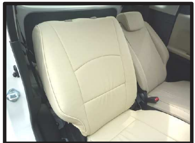
⑨ 2 列目運転席側背もたれの完成です。助手席側は一部形状が異なりますが同様に取り付けを行います。
