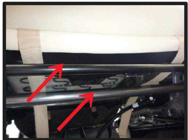
⑫シート前方に付いているベルトをシート裏から背面へ回します。ベルトは矢印部分の金属バーの上を通して下さい。
