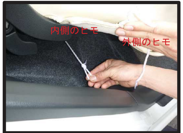
⑧カバーの両側面から出ているヒモをシートの外側面から取り出します。
