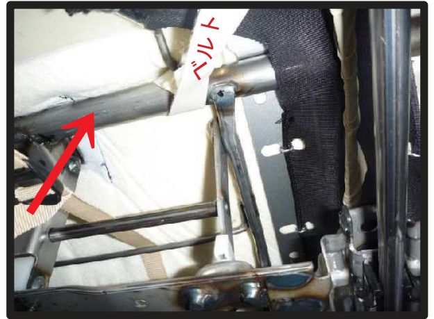
⑦マジックテープのベルトは矢印位置の太い金属バーに巻き付け固定します。ベルトの固定位置を間違えますとシートの可動時にベルトが切れる恐れがありますので、ご注意ください。
