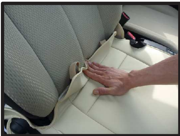
⑨背もたれと座面の隙間に生地を入れ込みます。背もたれの角度を調整して入れ込みやすい位置で行って下さい。
