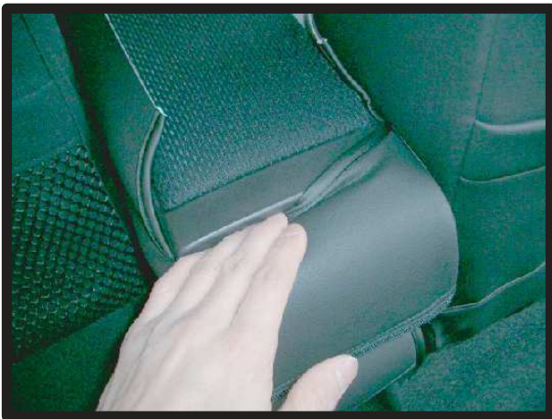
⑤アームレストのふた部分、付け根の位置に生地を入れ込みます。
