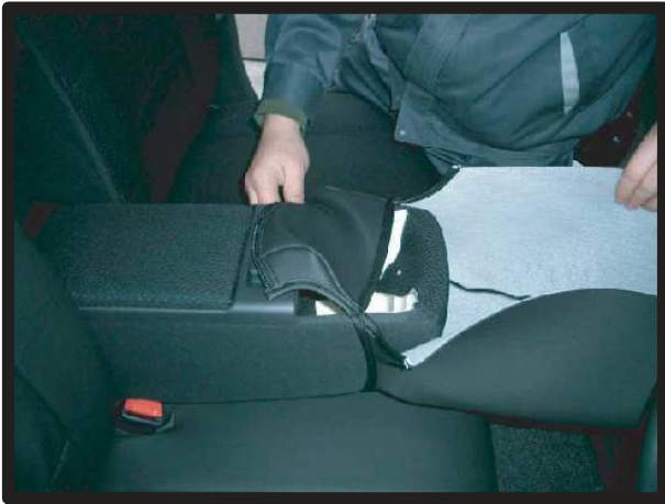
③ファスナーを開いてアームレスト前方よりカバーをかぶせていきます。
