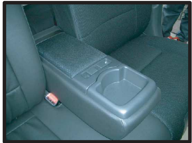
⑦ボックスのネジを締め固定し、完成です。
