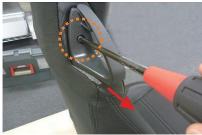
9 シート肩口のシートベルトガイドを外します。図のネジをドライバーを使用して外します。こちらのネジは太いネジで比較的堅く固定されているため、ドライバーはサイズの合った太めのドライバー（3番）を使用して下さい。ネジを外してシートベルトガイドを手前に引くようにして外します。
