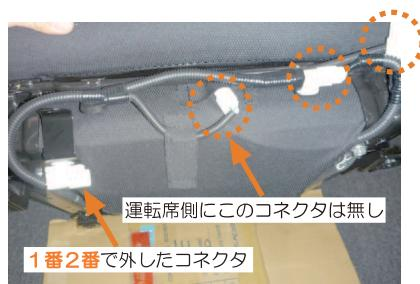
11 図は助手席側です。シートのクッションにつながっている配線を外します。**1番2番**で外したコネクタと同様に、運転席側は図の中央部分を除いた2か所、助手席側は、図の丸印部分3か所を外します。
