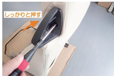
11 シートベルトガイドを元に戻します。カバーをかぶせることで生地が反発して、ネジ穴の位置が合わない場合があります。その場合は上側部分をしっかりと押してネジ穴の位置を合わせて下さい。
