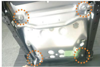
10 図はシートの裏側です。シートのクッションを固定しているボルトを外します。ボルトはソケットレンチなどを使用して外します。（ソケット12mm）
