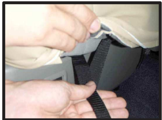
⑪カバー前部のベルトは、シートとプラスチック部の隙間を通して下さい。
