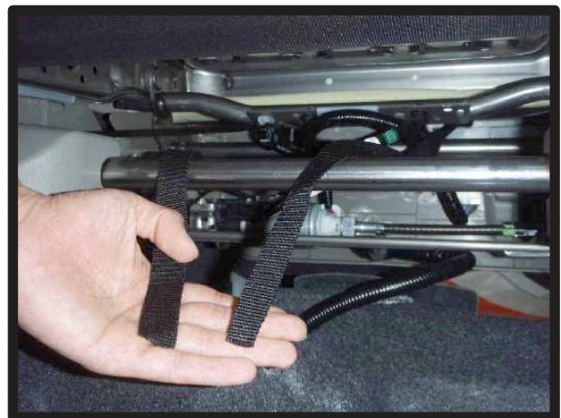
⑫座面底部にベルトを通します。 図のように金属バーの上側をベルトが通るようにします。 ※助手席側はシートアンダートレイの上側を通します。
