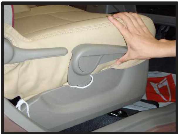
⑧座面横側の生地を、シートのプラスチック部に入れ込みます。 ※シートリフターがある場合は、座面の高さを一番上に上げて作業して下さい。
