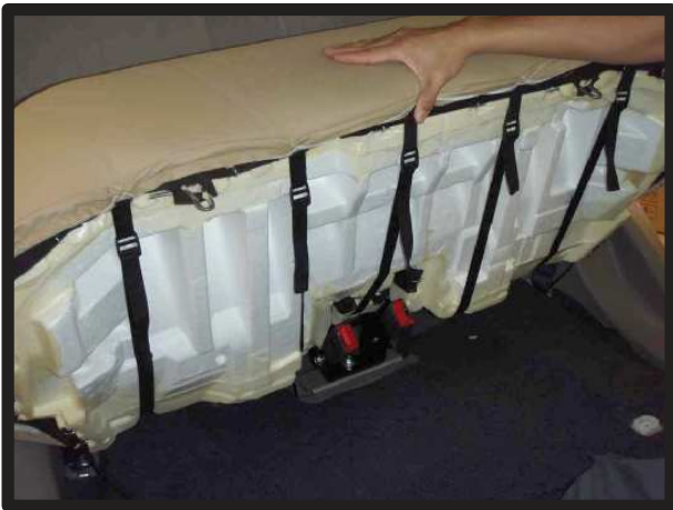
⑤座面を引き起こし、カバー前後のベルトを固定します。
