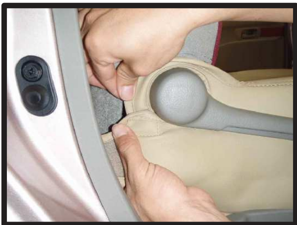
⑨リクライニングレバー部の生地をマジックテープで固定します。
