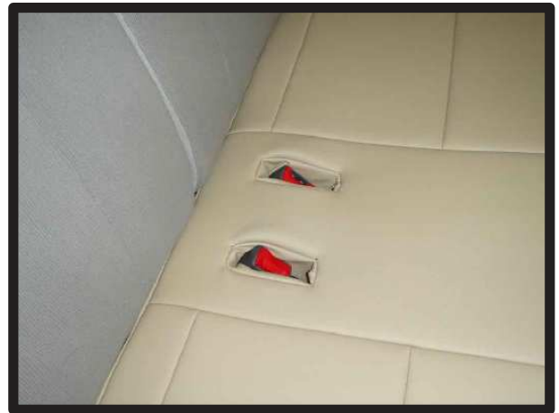
⑧シートベルトをカバーの穴部から取り出します。
