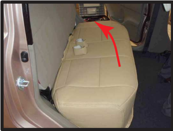
④シートのラインを整え、座面を矢印の方向に引き起こします。
