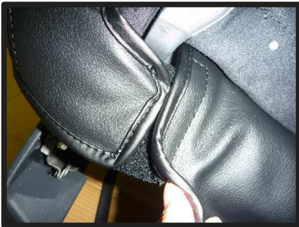
㉑カバー後ろにあるマジックテープに側面から後ろに回り込んでいる生地を固定します。
