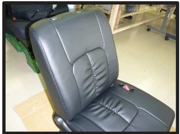
⑫カバーのラインを整えて運転席背もたれの完成です。 助手席側も同様に取り付けます。
