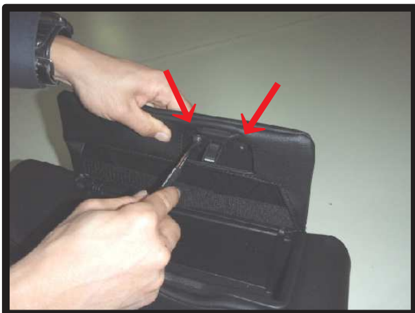
⑮⑩で外したプラスチックパーツを元に戻します。
