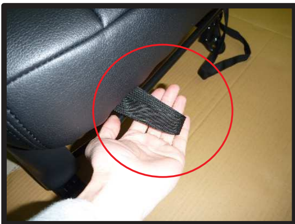
㉓カバー前部にあるベルト（2本）を座面下のスライドレバーの上を通して背面に引き出します。座面カバー後部のベルトと固定します。
