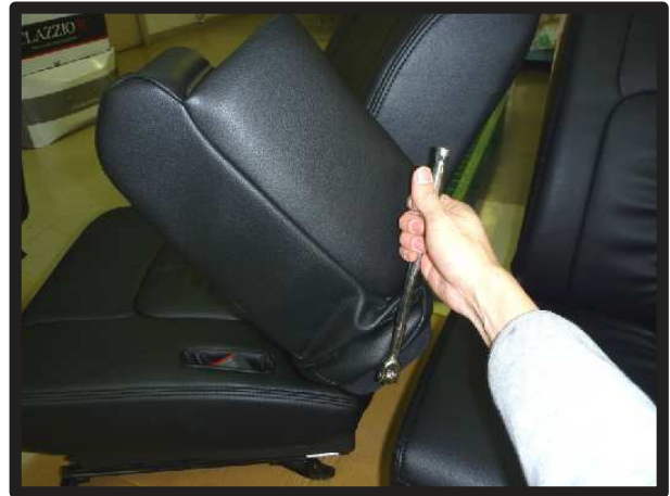
⑯アームレストを本体に戻します。 外した時と逆の手順で固定します。
