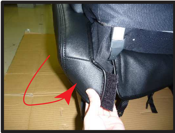
⑱側面後ろ側を包み込むように生地をかぶせます。
