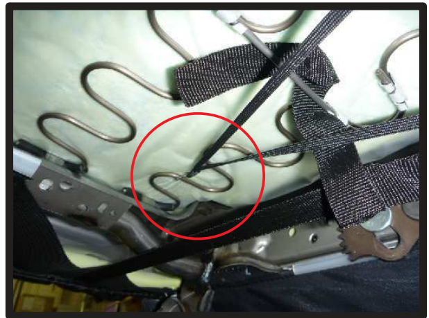
⑪座面裏側の金属バーに引っかけて固定します。
