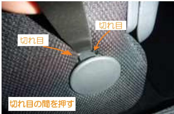
2 プラキャップはツメで固定されています。プラキャップの固定が固く外れない場合はヘラなどをプラキャップの根元に差しこみ切れ目が2本見える間の部分を押すと、ツメの固定が外れプラキャップが外れます。
