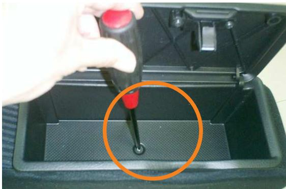
1 始めにボックス部分を外します。フタを開けると中にネジが1本あります。ネジをドライバーを使用して外します。
