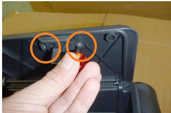
5 2番で外したボックスのフタにカバーをかぶせます。フタ裏の図の部分を、ドライバーを使用してネジを2本外して取り外します。
