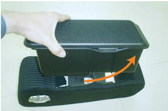
2 ボックス裏にツメが引っかかっているので図の矢印方向へスライドさせてボックスを外します。
