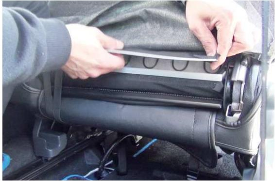
7 シート背面のシートを固定しているプラフックを取り外します。
