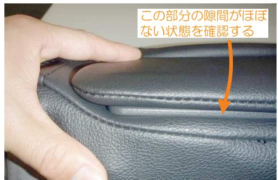
12 ボックスをアームレスト側のカバーの生地を生地を巻き込みながら、アームレストに戻します。この際ボックス裏のツメがしっかりかかるように意識して、元に戻して下さい。
