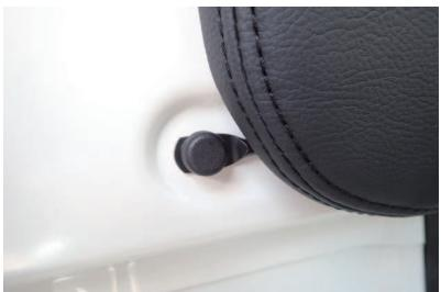
2 1番で示したボルト位置の内、下側の2箇所には、ボルトの上に図のようなカバーが付いています。
