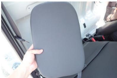
4 3箇所のボルトを外すと、ヘッドレストが車体から取り外せます。
