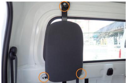
1 始めにヘッドレストを車体から取り外します。ヘッドレストは、図の3箇所（○部）にボルトで固定されています。
