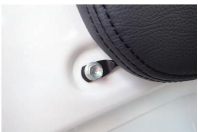
3 カバーを外すとボルトが見えますので、ソケットレンチ（10mm）を使用してボルトを外します。
