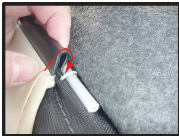
⑫引き出した生地が付いているプラフックを、⑪の赤線部（棒状のパーツの下側の針金状のパーツ）に引っ掛け固定します。
