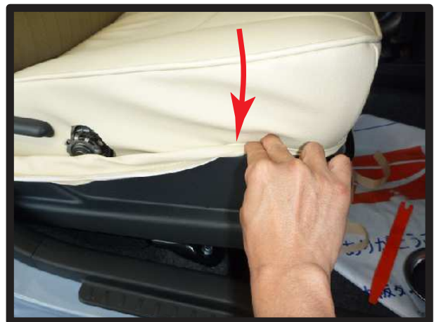
⑫側面の生地は、図のように座面のプラスチック部の隙間に入れ込みます。
