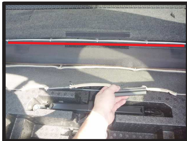
⑪⑧で入れ込んだ生地を、後ろ側から引き出します。 図の赤線部は、⑫で説明します。
