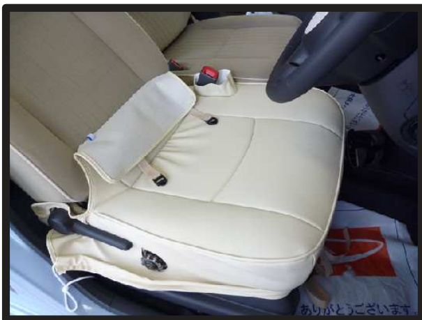
⑨ラインがずれないように、カバーを座面全体にかぶせます。
