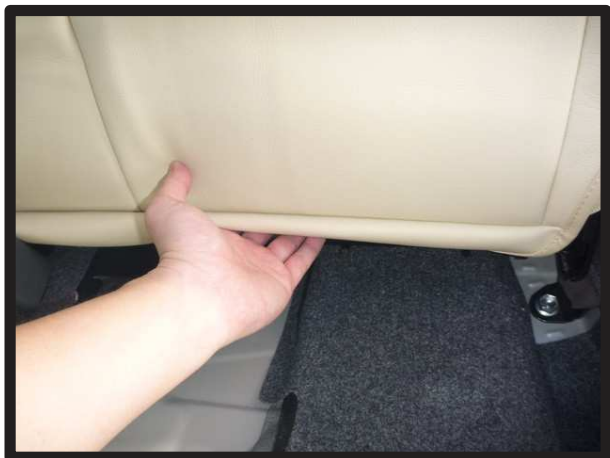
⑧カバー前側のプラフックの付いた生地を、シートの隙間に入れ込みます。 ※この際、チャイルドシート固定用金具の上側を生地が通るようにして下さい。
