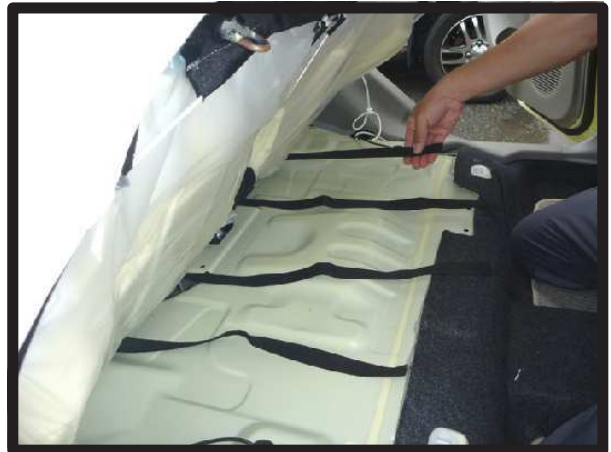
⑩ シート前方を持ち上げて、7ページの⑥で入れ込んだベルトを引き出します。
