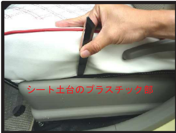
②⑤ 助手席側の外側面は、カバー外側面のプラスチックの板を、シートとシート土台のプラスチック部の隙間に入れ込みます。
