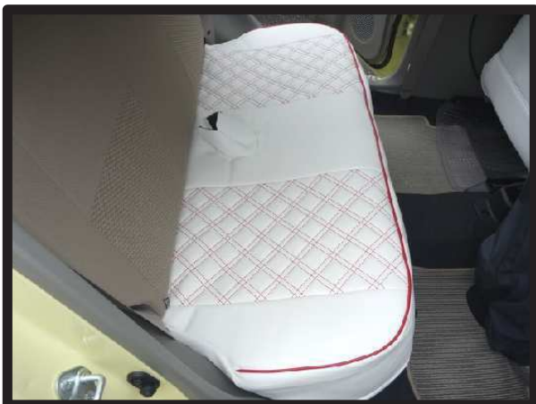
⑨ シートのラインからずれないようにカバーをシート全体にかぶせます。
