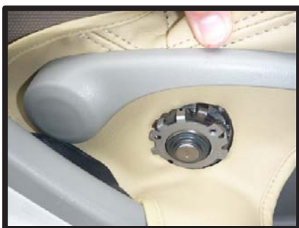
⑫生地の伸びを利用して、ゆっくりとレバーを抜き出します。作業は慎重に行ってください。カバーの加工穴からシートリフターの軸を出します。
