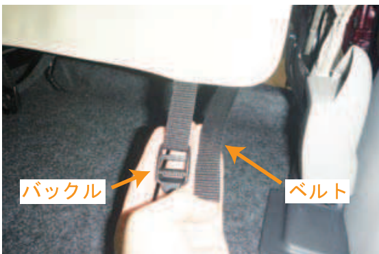
21 シート背面側からベルトを引き出して、カバー背面側のバックルと固定します。
