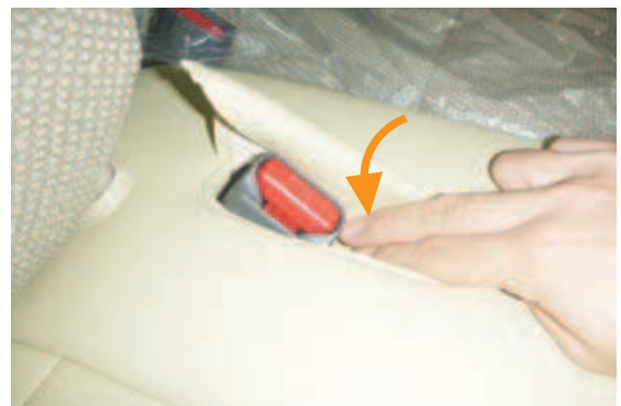
23 シートベルトバックルをカバーの加工穴から取り出し、生地を加工穴の中へ入れ込みます。
