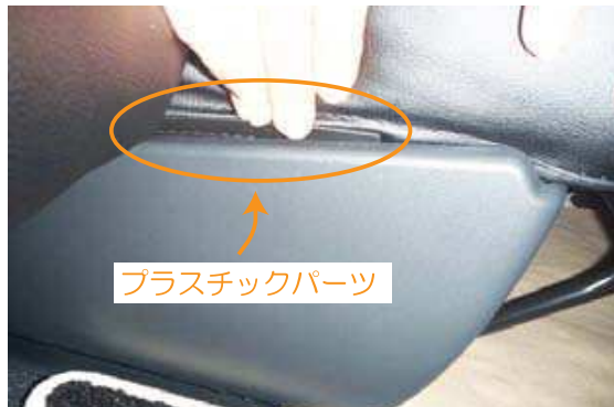
13 カバー内側に付いているプラスチック部分をシートの際間に入れ込みます。
