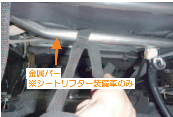
20 カバー前側に付いているベルトを、シート裏を通してシート背面へ回します。シートリフター装備車はシート裏の金属バーの上を通すようにして下さい。
