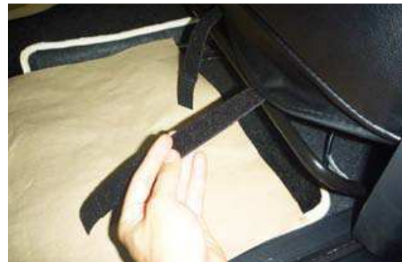
16 カバー前側に付いているマジックテープベルトをシート底面の金属部分に巻き付けるようにして固定します。
