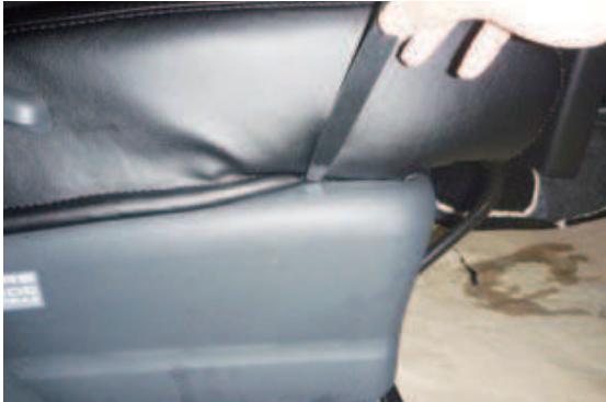
19 シートリフター未装備車は、カバー外側面の生地をシートの間隙に入れ込みます。
