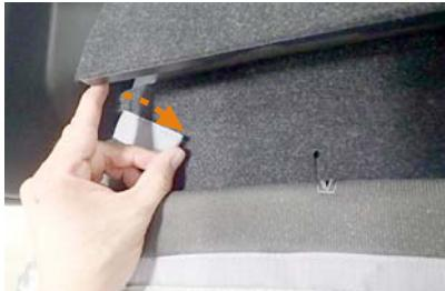
7 26ページ4番でシートの背面から引き出したマジックテープを、直接シートに貼り付けて固定します。
