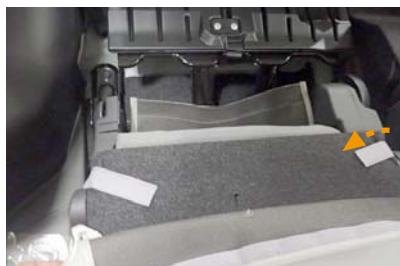
8 26ページ5番でシートの背面から引き出したマジックテープも、直接シートに貼り付けて固定します。
