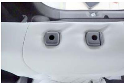
2 ヘッドレストの台座をカバーの加工穴から取り出します。
