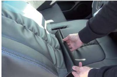
5 プラフックの付いた生地を、背もたれと座面の隙間に入れ込み、背面から引き出します。プラフックでカバーに傷をつけたりしないようにご注意ください。
