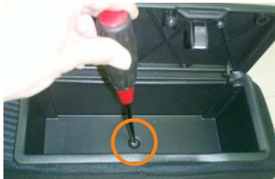
4 始めにボックス部分を外します。フタを開けると中にネジが1本あります。ネジをドライバーを使用して外します。
