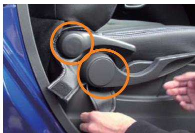
8 5ページ4番で通しておいたレバーを、カバーの加工穴部分から抜き出します。穴は少し小さめに開けているので、レバーの軸部分を抜き出す際は、慎重に行ってください。
