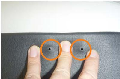
11 ネジの位置に印しを付けるなどして、付けた印し部分を少し切り込みます。
