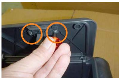
8 5番で外したボックスのフタにカバーをかぶせます。フタ裏の図の部分を、ドライバーを使用してネジを2本外して取り外します。
