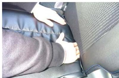
2 背もたれと座面の隙間に生地を入れ込み、座面奥にマジックテープで固定します。
