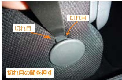
2 プラキャップはヘラなどを根元に差し込み切れ目が2本見える間の部分を押すと、ツメの固定が外れプラキャップが外れます。無理に外そうとすると、プラキャップが変形するのでご注意ください。
