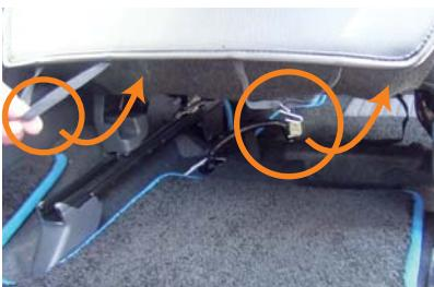
11 カバー背面下に付いているゴムに、付属の金属フックを取り付け、座面底部の金属部にフックを引っ掛けます。
