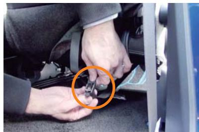
12 ベルトをシート裏へ引き出し、カバーの生地に付いているバックルに通して固定します。
