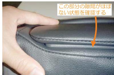
15 ボックスをアームレスト側のカバーの生地を生地を巻き込みながら、アームレストに戻します。この際ボックス裏のツメがしつかりかかるように意識して、元に戻してください。
