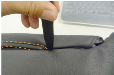
16 アームレストとボックス部分の隙間に、ボックスのフタに付けたカバーの端を、ヘラなどを使用して入れ込みます。点線で囲んだ生地のフチ部分が全て見えなくなるほどしっかりと入れ込んでください。
