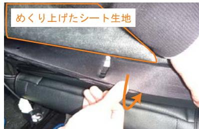
8 5番で引き出したプラフックに、7番で取り外したプラフックを取り付けます。プラフックを取り付ける際に、取り付る時に邪魔になるめくり上げているシート生地をあまり上に引き上げすぎると、プラフックも一緒に上に上がってしまい取り付けが困難になりますので、めくり上げるシート生地はあまり引き上げないでください。
