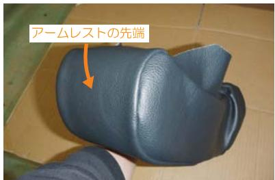
6 アームレスト本体にカバーをかぶせます。カバーのファスナーを開けて、アームレストの先端まで生地が張る様に、ファスナー部分からカバーをかぶせます。
