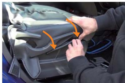
7 カバー側面の生地をシートとプラスチック部の隙間に入れ込みます。
