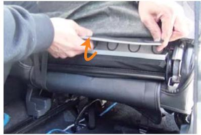
7 シート背面のシート表皮を固定しているプラフックを取り外します。
