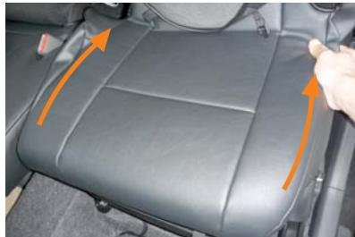
16 助手席は図のようにシートの前側からシートの付け根にかけてかぶせていきます。シート底部にトレーがある場合は、抜き出してから作業を行ってください。
