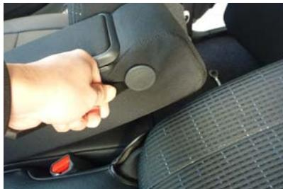
1 始めにアームレストを外します。アームレストに付いているプラキャップを、ヘラなどを使用して外します。
