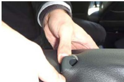
6 ヘッドレストの台座を取り出します。まず台座の片側のフチに、生地をしっかりと入れ込み、生地の伸びを利用して台座を取り出します。
