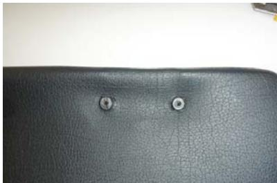
12 切り込んだ部分からネジ穴を図のように取り出します。
