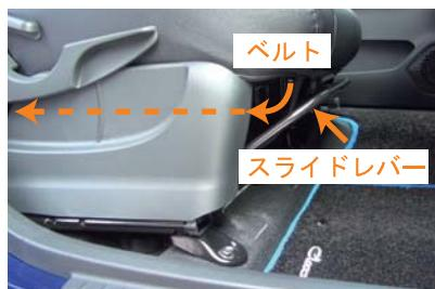
11 ベルトを底面を通し、背面へ引き出します(2本)。ベルトはスライドレバーと座面の間を通して通します。
