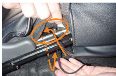
3 外側側面のヒモを、写真の生地部分をめくり上げてシートとシートレールの隙間に通し、シート底面部にヒモを引き出します。
