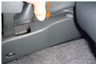
17 カバー内側側面の生地は、シートとプラスチック部の隙間にに入れ込みます。その他の部分は運転席と同様の固定方法で取り付けてください。
