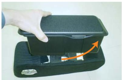
5 ボックス裏にツメが引っかかっているので図の矢印方向へスライドさせてからボックスを外します。
