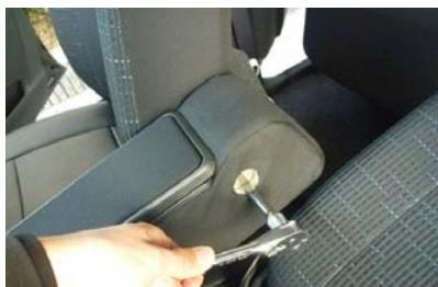
3 プラキャップを外すと中にボルトがあります。ソケットレンチ（14mm）などを使用してボルトを外し、アームレストを背もたれから取り外します。
