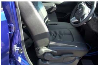
15 シートリフター装備車はレバー軸部分の下に生地を入れ込み、シートを下げる際に生地がたるむ場合は再度調整してください。カバーのラインを整え、1列目運転席座面の完成です。
