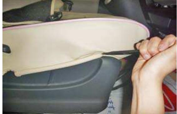
**10** カバーの生地をシートとプラスチックの隙間に入れ込みます。
