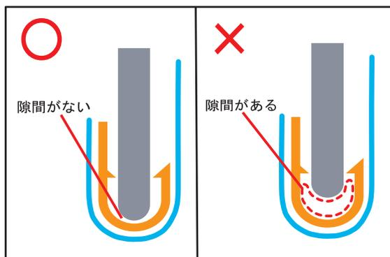
**10** 正しく固定されると図のようになります。ブラフックとシートに隙間ができないようにシートの骨組みにブラフックがはまり切るまではめ込んで下さい。
