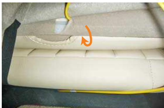
**8** 6番で引き出したカバーに付いているプラスチックフックを、4番で取り外した純正のプラスチックフックにはめ込み固定します。
