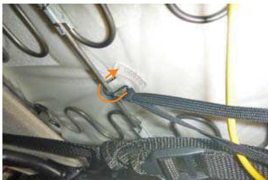
**11** 図のようにシート底面には金属の骨組みがあるので、その部分に金属フックを引っ掛けて固定します。
