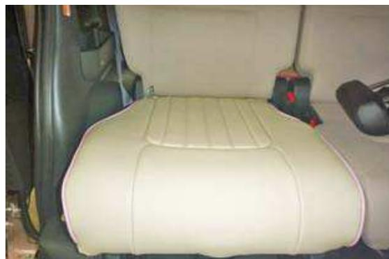
**12** カバーのラインを整えて、2列目運転席側座面の完成です。助手席側も同様に取り付けます。
