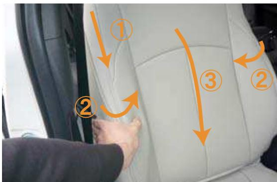
**7** カバー側面の生地を、図の①～③の順番でシートに密着させるようにして、シワをなくしていきます。側面の生地がしっかりと張るまで繰り返して行って下さい。
