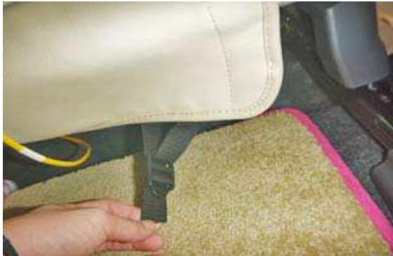
**13** 12番で後ろに通したベルトを、7番で引き出した生地の下に付いているバックルに通して固定します。
