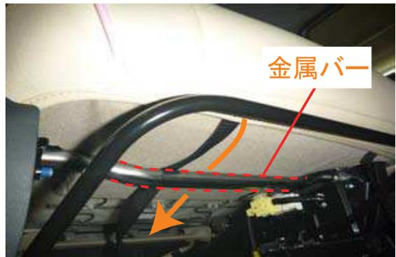
**12** カバーの前側のベルトをシートの後ろ側に通します。この際、ベルトはシート底の金属バーの上を通して下さい。
