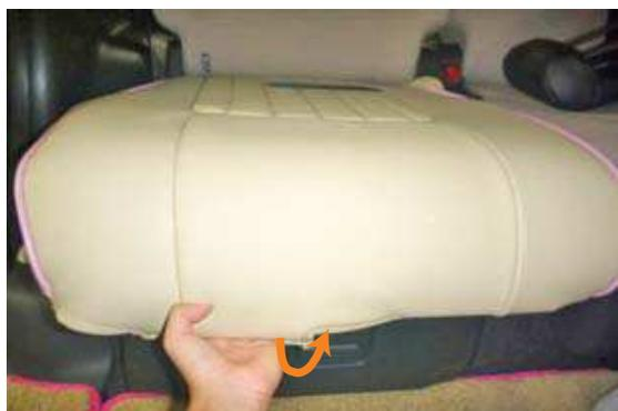
**7** カバーの生地ごと内に巻き込みながら、シート本体に引っ掛けて固定します。この時シートの骨組みにブラフックがはまり込む音がするまで、しっかりはめ込んで下さい。
