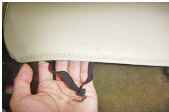
**10** カバーの背面の一番下にゴムが付いています。ゴムに付属の金属フックを取り付けシート底面に引っ掛けて固定します。
