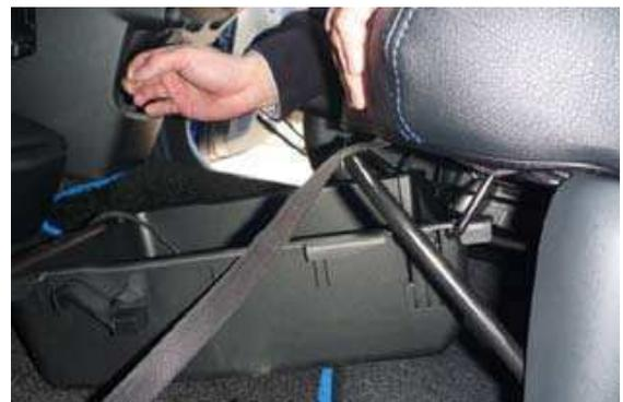
**17** 助手席側も一部形状が異なりますが運転席側と同様に取り付けます。カバー装着の前にシート底面のトレーを引き出してから作業を行って下さい。
