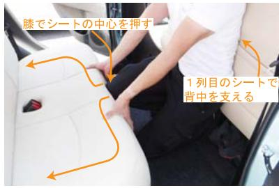
17 バックル側の穴が車体側の穴よりも手前に来る場合は、シートが手前に押し出されている可能性がある為、図のようにシートを膝で奥に押し込んで下さい。
