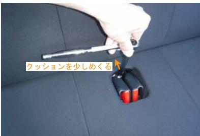
**1** ソケットレンチ（14mm）を使用し、シートベルトバックルを固定しているボルトを外します。
