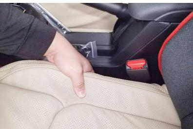
14 カバー内側面の生地裏に付いているマジックテープをシート表皮に直接貼り付け固定します。
