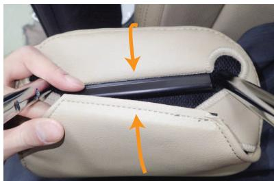
3 ヘッドレストを取り外し、カバー前後に付いているプラフックを固定します。
