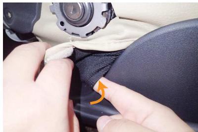
17 シートリフターの軸部分の下にある純正表皮の隙間に、生地から飛び出しているマジックテープを入れ込みます。
