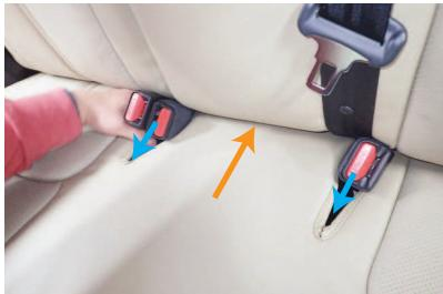
**19** 背もたれと車体の間にシートを差し込み、バックルをシートの収納部に入れ込みながら奥に押し込んでいきます。奥まで押し込めたら、16ページ4番で外したフックの固定を元に戻します。
