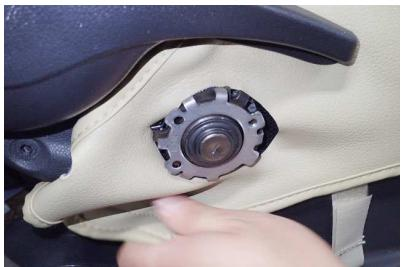
14 シートリフターの軸部分と、カバーの加工穴の位置を合わせます。
