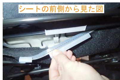
2 運転席側と同様に、目隠し用生地を固定しているプラフックを外します。
