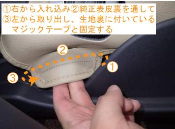
19 純正表皮に巻き付けたマジックテープを側面に引き出し、生地裏に付いているマジックテープと固定します。
