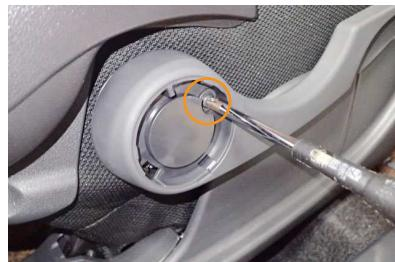
6 フタを外した所にあるネジをドライバーを使用して外し、レバーをシートから外します。
