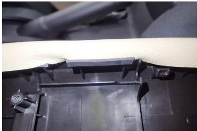
7 樹脂のツメにカバーを引っ掛けると図のように仕上がり、カバーが外方向に逃げにくくなります。
