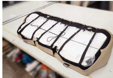
10 軽めに固定していたベルトをしっかりと固定し直します。
