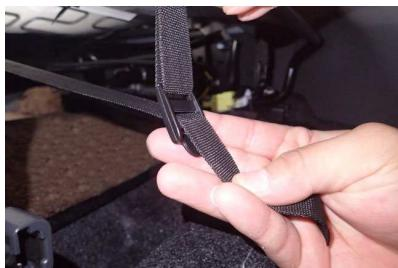
24 ベルトをシートの前側から引き出し、カバーの前側に付いているバックルと固定します。
