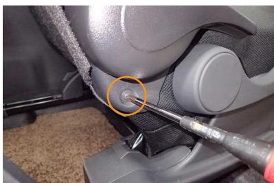
2 リクライニングレバー下部のネジをドライバーを使用して外します。
