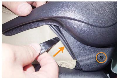
11 ヘラ等を使用し、リクライニングレバー下部のプラスチックカバーとシートの隙間にカバー外側面の根本に付いている固定部材を入れ込みます。
