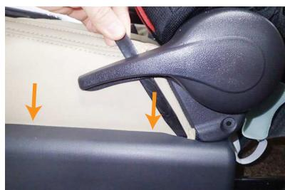
10 カバー外側面に付いている固定部材をシートとの隙間に生地ごと入れ込みます。
