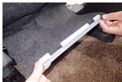
4 固定を外した後、背面側へ目隠し用生地を引き出しておきます。
