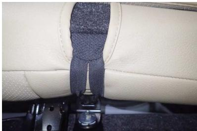
6 カバーの切れ込み部分でシートベルトを固定しているゴムを交わして下さい。
