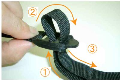
**25** ベルトの通し方は、図の①～③の順番にベルトをバックルに通し、引く事でベルトが締り固定されます。
