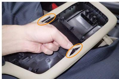
5 カバーが外方向に逃げるのを防ぐ為、両サイドのカバーのフチにハサミ等で切れ込みを入れ、樹脂のツメに引っ掛け固定します。詳しくは6番を参照してください。
