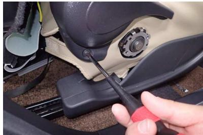
16 穴位置を合わせた後、生地を挟み込んだ状態で、ネジを元に戻します。
