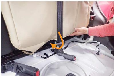
5 カバーをシートにしっかりと馴染ませた後生地を背もたれと車体の隙間に入れ込みます。隙間には16ページ4番で外したフックの片方がある為、生地がフックに引っ掛からないように、生地をフックとシートの隙間に通して下さい。
