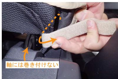
18 入れ込んだマジックテープを、純正表皮に巻き付けるようにしてシート背面から取り出します。
