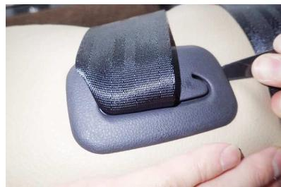
11 ヘラ等を使用し、シートベルト付け根のプラスチックパートとシートの隙間に生地を入れ込みます。
