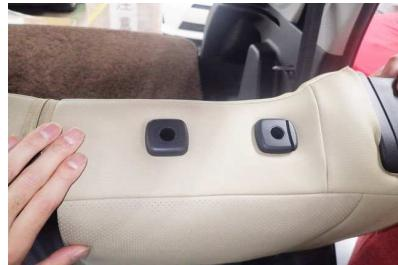
10 カバーの加工穴からヘッドレストの台座を取り出します。
