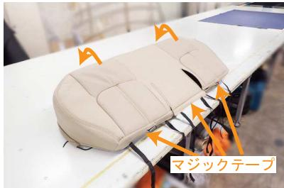
7 図の位置にあるマジックテープをシートに直接貼り付け固定した後、カバーをシート全体にかぶせます。
