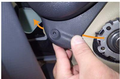
15 5ページ1番で外したネジが固定されているプラスチックカバーの内側に生地を通して生地の加工穴と、ネジ穴の位置を合わせます。
