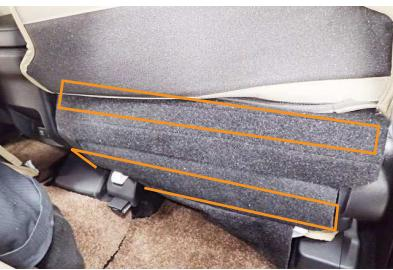
9 カバー背面下部の生地裏に付いている2本のマジックテープを、目隠し用生地に直接貼り付けて固定します。
