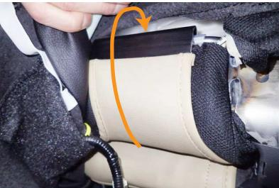
7 背面から引き出した生地に付いているプラスチックフック（2箇所）を、目隠し用生地で隠れている金属フレームに引っ掛けで固定します。**フックがフレームに届かない場合は、カバーを上から下へしっかりととなじませ直して、背面側から生地を引き出して下さい。**
