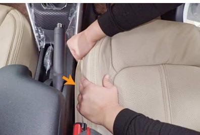
21 カバー内側面の生地裏に付いているマジックテープをシート表皮に直接貼り付けて固定します。
