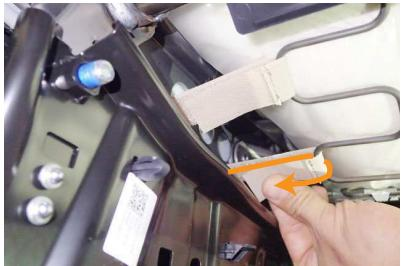
13 引き出したマジックテープをシート裏の金属部分に巻き付けて固定します。
