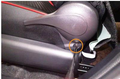
7 リクライニングレバー下部のネジをドライバーを使用して外します。
