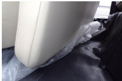
① シート格納時にフロアに干渉する部位（背もたれ先端部）の下に、摩擦を低減させる為にビニールなどを敷いておきます。
