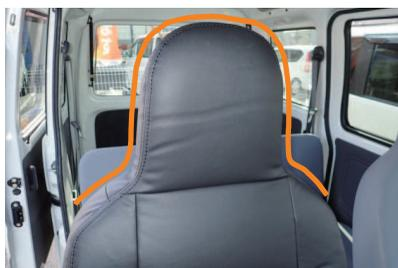
2 シートのラインに合わせてカバーをかぶせます。カバー先端の生地が張るようにしっかりとかぶせて下さい。
