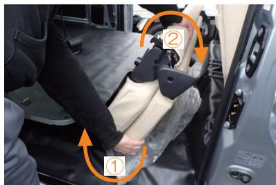
② この状態で、①背もたれを引き上げるようにしながら、②座面を押し込むようにすると、シートが回転しやすくなります。
