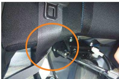
1 ソケットレンチ（10mm）等を使用して2列目背もたれシートの下にあるボルトを外します。
