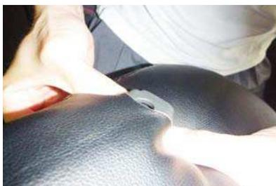
3 ヘッドレストの台座をカバーの加工穴から取り出します。図のように台座の片側を加工穴から取り出し、生地の伸びを利用して台座全体を取り出します。
