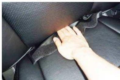
4 背もたれと座面の隙間に生地を入れ込みます。背もたれの角度を調整して入れ込みやすい角度で行ってください。
