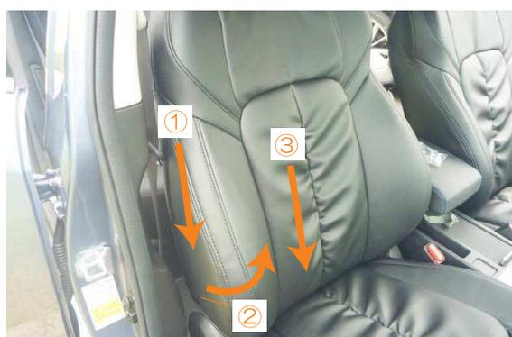
8 カバー側面の生地を、図の①～③の順番でシートに密着させるようにして、シワをなくしていきます。側面の生地がしっかりと張るまで繰り返し行って下さい。
