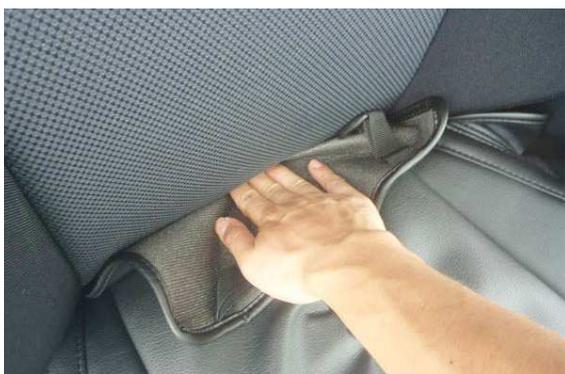
2 背もたれと座面の間隙に生地を入れ込みます。背もたれの角度を調整して入れ込みやすい角度で行ってください。
