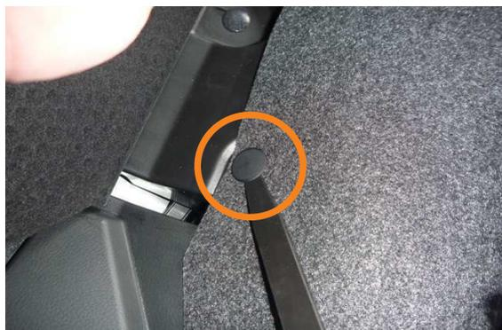
1 シート背面からラゲッジにつながっている生地を固定を外します。ラゲッジにピンで固定されていますので、手前に引いてピンを外します。
