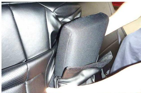
4 カバーをシートのラインに合わせて全体にかぶせます。かぶせる際に加工穴からアームレストを出しておきます。
