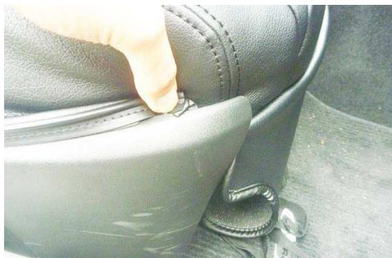
4 カバー外側面の生地をシートの間隙に入れ込みます。
