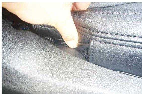
5 カバー外側面後ろ側の生地をシートの間隙に入れ込みます。
