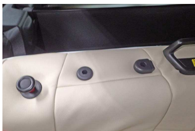
9 1列目背もたれと同様にヘッドレストの台座をカバーの加工穴から取り出します。
