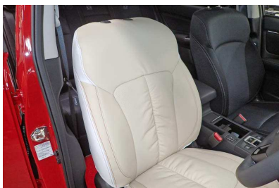
16 カバーのラインを整えて、1列目運転席背もたれの完成です。助手席も同様に取り付けます。
