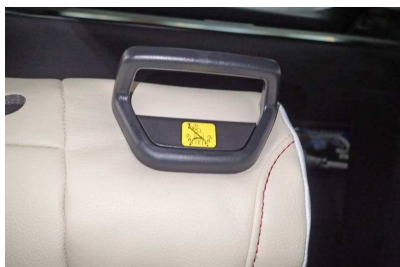
7 シートベルトガイドを取り出した図です。 (運転席側のみ)
