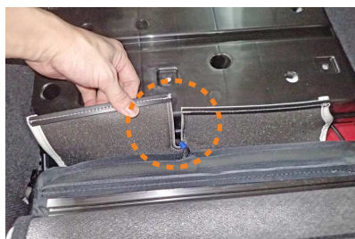
12 入れ込んだ生地を背面側から引き出します。 中央の配線をカバーの切れ目でかわします。
