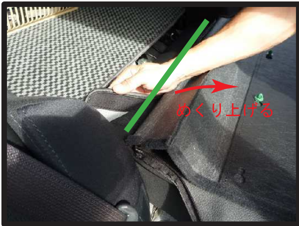
⑧引き出した生地を7ページ①で外した生地をめくり上げた場所（図の緑のライン）へ、マジックテープで直接固定します。
