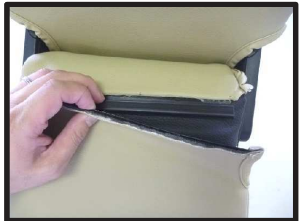
⑫入れ込んだ生地を引き出し、図のように生地同士をプラフックで固定します。
