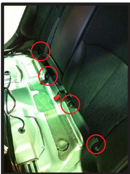
③図の○位置にあるボルトを、ラチェット等を使用し外します。
