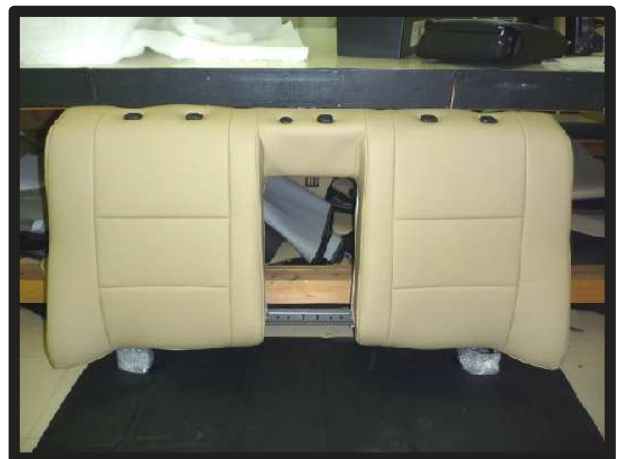
⑫ カバーのラインを整え、2列目背もたれの完成です。 背もたれは、アームレスト完成後に車体に戻します。
