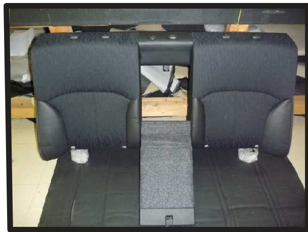
⑤外した背もたれを車外へ移します。運び出す際に、車体を傷付けないよう、注意して下さい。
