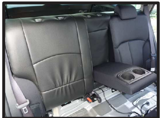
⑫カバーのラインを整え、2列目背もたれの完成です。 助手席側も一部形状が異なりますが、同様に取り付けます。
