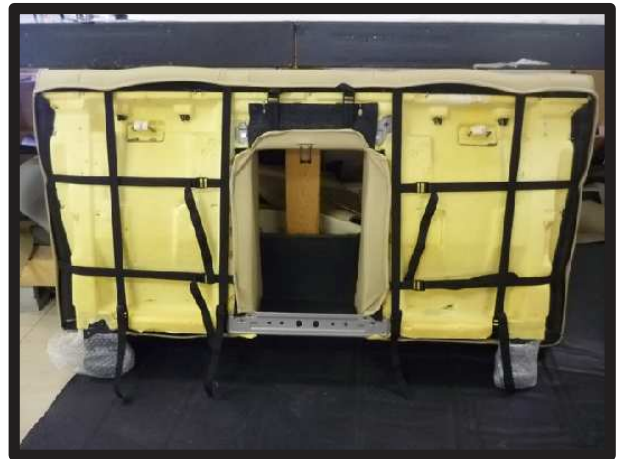
⑪カバーは背面に付いているベルトで固定します。
