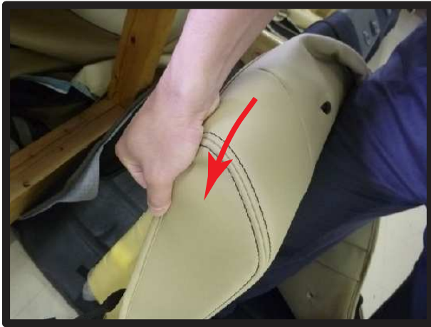
⑦背もたれにカバーをかぶせます。 肩口までしっかりかぶせて下さい。
