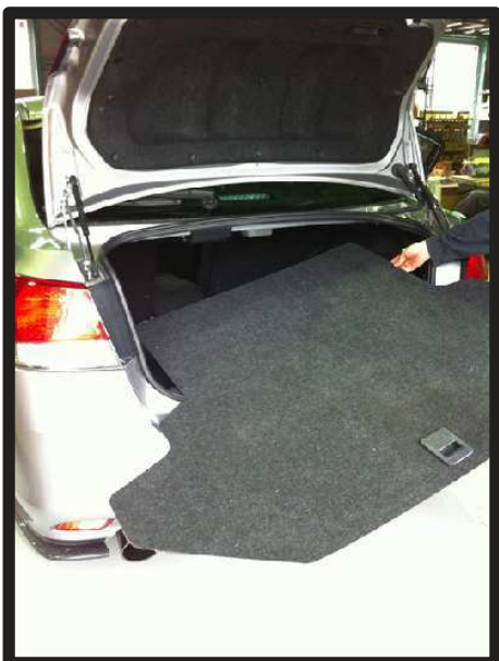
①始めにトランク内から、ラゲッジボードを取り外します。
