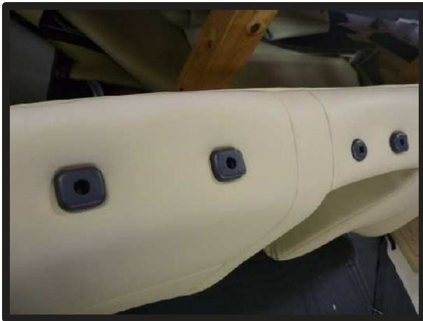
⑧1列目と同様に、ヘッドレストの台座を取り出します。
