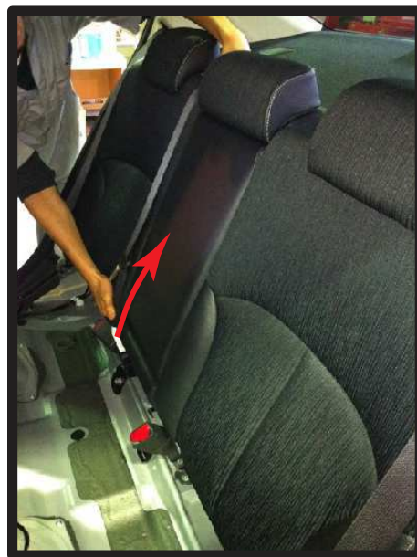
④ボルトを外し、図の矢印方向に持ち上げるようにすると、背もたれが取り外せます。
