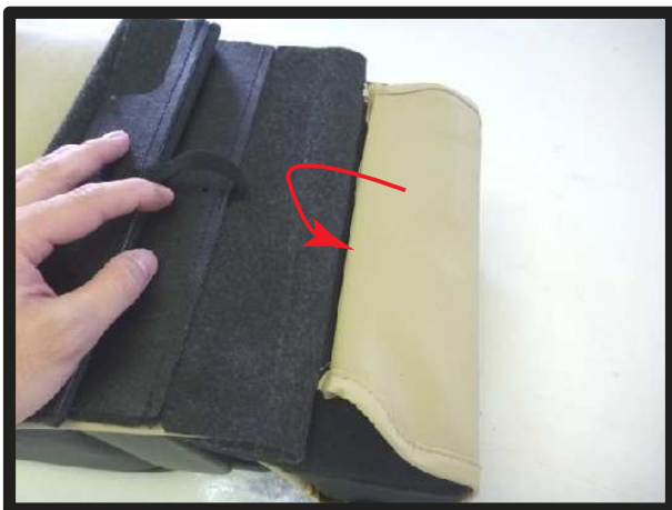
⑨引き出した生地を、9ページ②で外した生地の代わりにフックに固定します。
