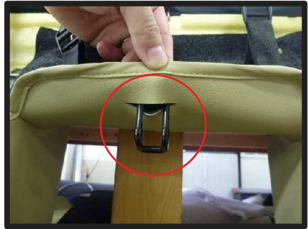
⑩アームレスト収納部上側に金具が付いているので、カバーの加工穴から取り出します。
