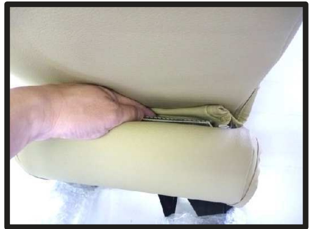
⑪カバー前側の生地をアームレストの隙間に入れ込みます。
