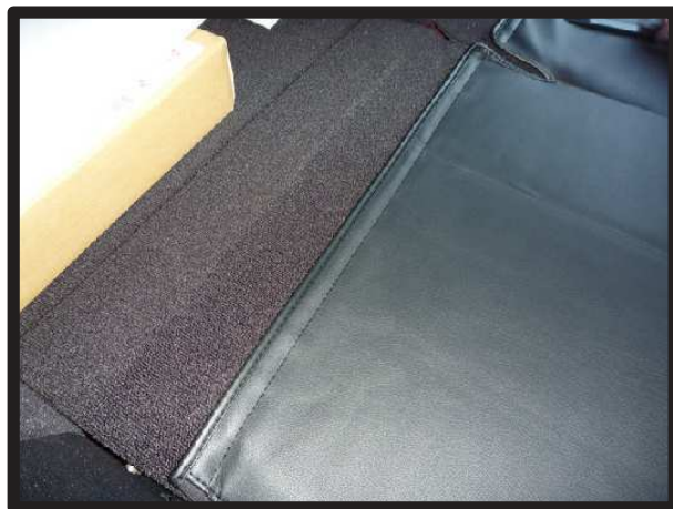
⑩カバー背面の生地は、マジックテープで直接シート背面に固定します。
