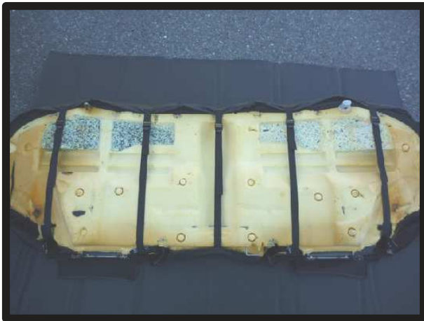
⑧シートを裏返し、カバー前後のベルトを固定します。
