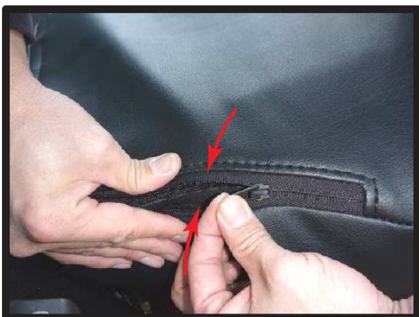
⑨カバー側面の生地を内へ寄せながらファスナーを閉じます。
