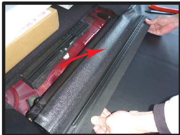
⑪シート背面の生地を、図のようにめくり上げます。
