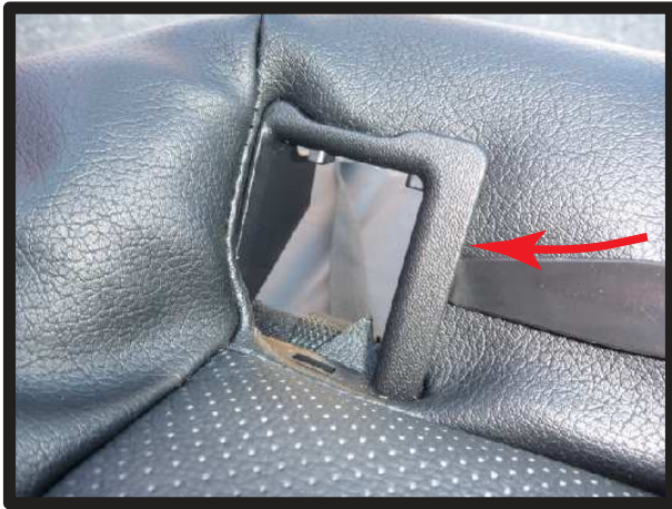
⑦ヘラ等を使用し、パーツの隙間に生地を入れ込みます。
