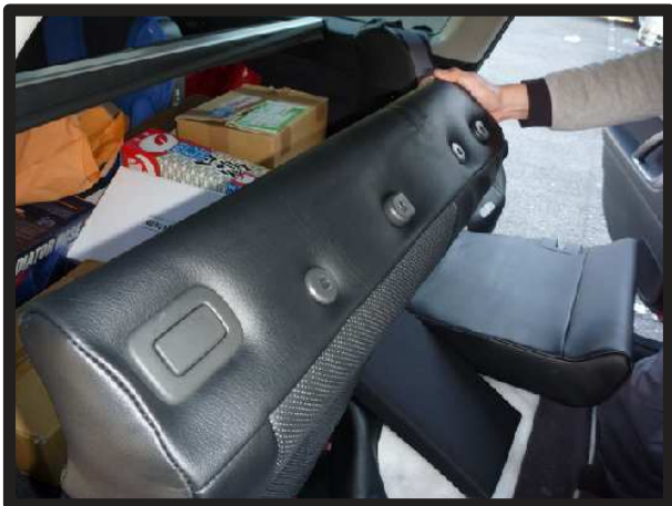
⑦ヘッドレストの台座部分を、1列目と同様に取り出します。
