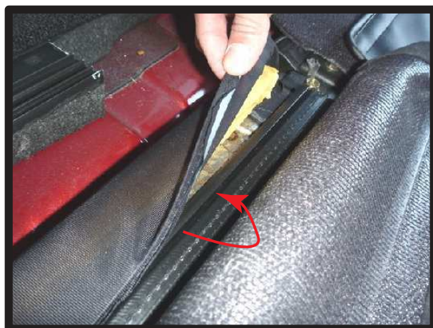
⑫シートに生地を固定しているプラスチックパーツを、図のように取り外します。
