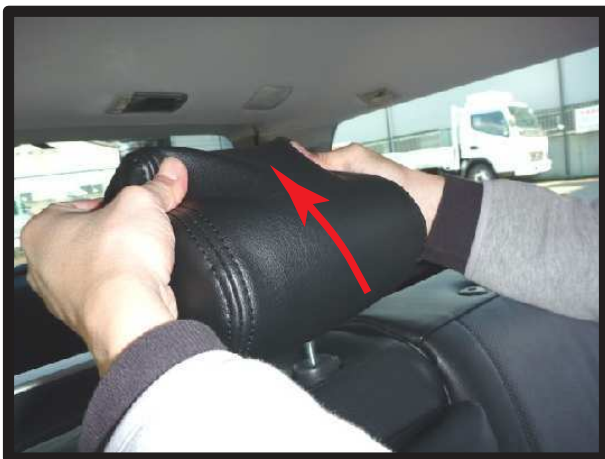
⑨ 2列目中央ヘッドレストは、カバーを前側に引っ掛けるようにしながらかぶせます。固定方法は、同様になります。
