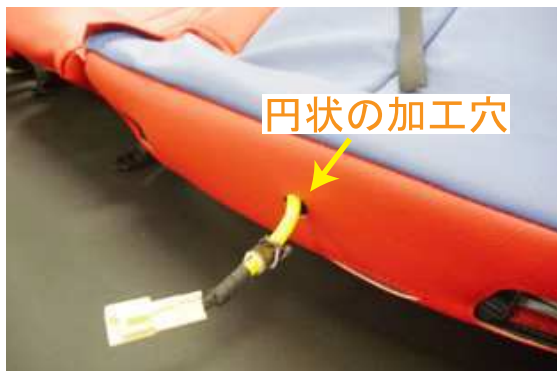
9 シート後部から出ている配線を、カバーの加工穴から取り出します。
