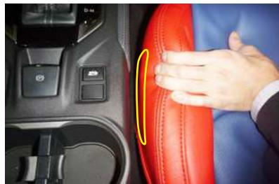
10 内側面の生地裏に付いているマジックテープを、シートに直接貼り付け固定します。
