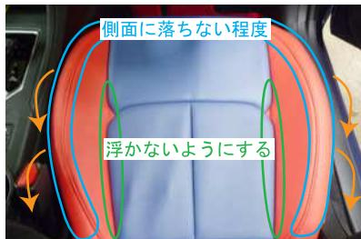
7 図を参考に、シート全体にカバーを馴染ませます。○の箇所を浮かないように手で押さえながら、○の細い部分の分割ラインが側面に落ちない程度に側面を下に引っ張ります。
