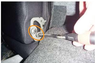
2 図の2箇所のネジをドライバーを使用し、外します。
