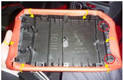
7 生地を内側に折り返し、両面テープで固定します。図の後ろ側のネジ穴はふさがないようにして下さい。
