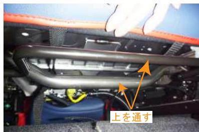
11 手動シート車はカバー前面に付いているベルトを、スライドレバーやシート裏の金属バーの上を通し背面側に通します。
