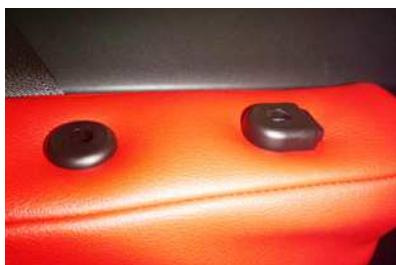
6 ヘッドレストの台座をカバーの加工穴から取り出します。
