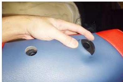
4 生地の伸びを利用して、ヘッドレストの台座を加工穴から取り出します。
