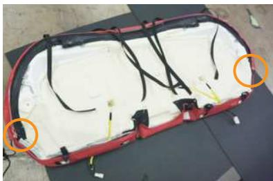
**13** カバーを裏返し、カバー左右（図の○印）から出ているヒモを固定します。
