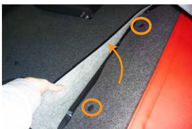
9 シートを倒し、付け根部分にある生地をめくると、図のように生地が2つのピンで固定されている為、ピンを外します。
