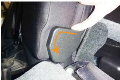
1 助手席側の背もたれを倒し、中央アームレストの付け根部分のプラスチックカバーを外します。図のように反時計回りに回すようにすると外れます。
