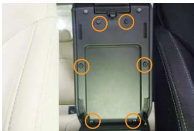
1 コンソールのフタを開け、図の6箇所のネジをドライバーを使用して外します。
