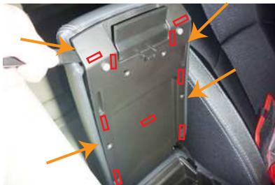
2 隙間にヘラ等を差し込み、プラスチックカバーをフタから外します。プラスチックカバーとフタはツメ（図の□印）で固定されている為、無理に外そうとすると、破損する恐れがある為、慎重に作業を行って下さい。
