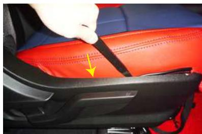
8 ヘラ等を使用し、外側面に付いている固定部材を生地ごとプラスチックとシートの隙間に入れ込みます。
