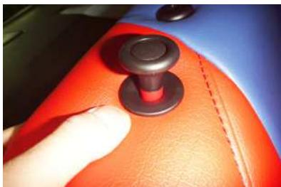
7 シート端のリクライニングレバーを、台座ごとカバーの加工穴から取り出します。
