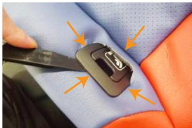
10 ヘラ等を使用し、チャイルドシート固定用フックのプラスチックカバーとシートの隙間に生地を入れ込みます。
