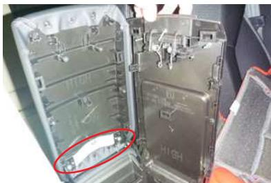
3 プラスチックカバーをフタから外し、図の位置にあるネジ3本をドライバーを使用して外します。
