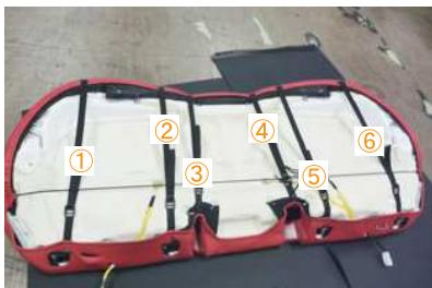
**15** カバー前後に付いているベルトとバックルを固定します。（計6箇所）
