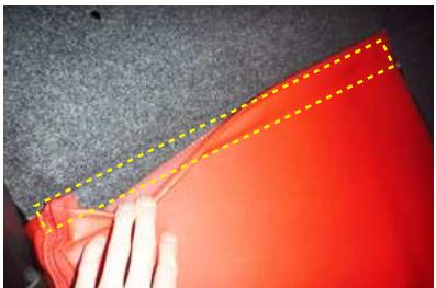
15 カバー背面下の裏側に付いているマジックテープを、シートに直接貼り付けて固定します。
