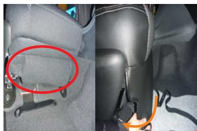
12 パワーシート車は前面の生地が長めに作られています。カバーで純正シートの○部分を覆いながら、ベルトを背面へ通します。シート裏には配線が通っている為、配線を交わしながらベルトを通して下さい。
