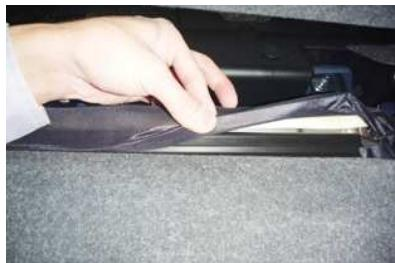
10 生地をめくると、シート表皮を固定している図のようなプラスチックパーツがあるため、固定を外します。フック状になったプラスチックに、板状のプラスチックがはめ込まれて固定されているため、板状のプラスチックを引き抜くようにして下さい。
