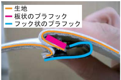
14 フック状になっているプラスチックに板状のプラスチックを、生地と共に折り返して挟み込み固定します。
