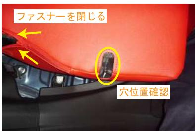
8 図のように、シートと車体の連結部分がカバーの加工穴と合うようにカバーを馴染ませ、ファスナーを閉じます。
