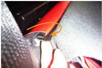
13 14ページ10番で外した固定用プラスチックの内、フック状のプラスチックに、14ページ12番で引き出した生地に付いている板状のプラスチックをはめ込み固定します。
