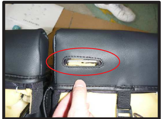
⑰シートベルトバックル部裏側に付いている金具は、カバーの加工穴から取り出します。
