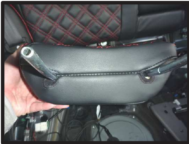
⑧ ヘッドレストを台座から取り外し、底面のプラフックで固定します。 ※固定方法は巻末のプラフックの固定を参照します。
