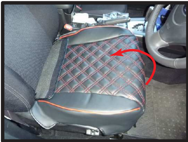
⑦カバーを固定した前側を支点に、シート全体へかぶせます。
