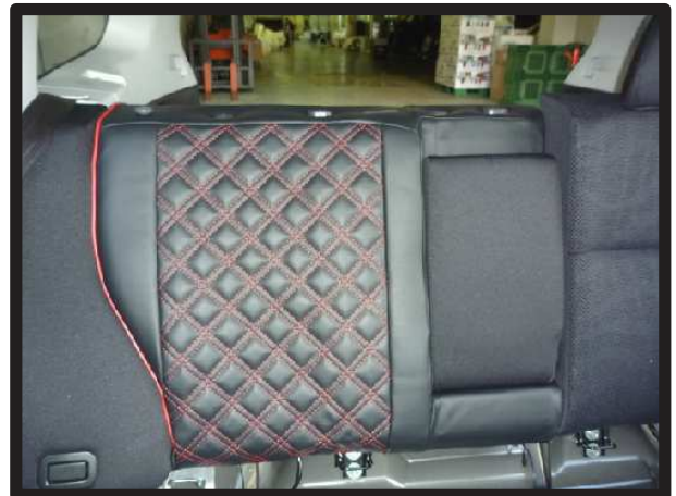
㉒カバーのラインを整え、2列目運転席側背もたれの完成です。助手席側は一部形状が異なりますが同様に取付けます。
