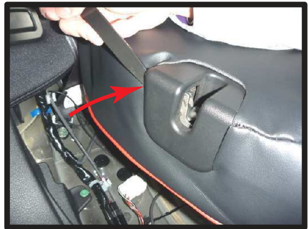
⑯シート外側面のヒンジのあるプラスチックパーツの隙間に、ヘラ等を使用し、生地を入れ込みます。
