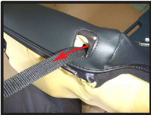
⑬7ページ⑫で通したベルトは、かぶせたカバーの加工穴にも通すようにします。
