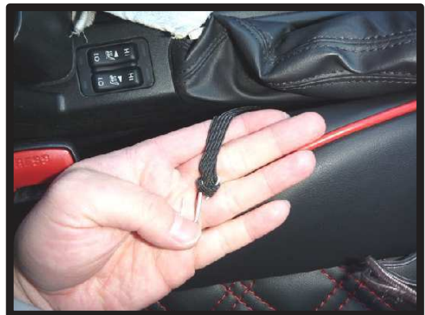
⑪カバー内側面の生地についているゴムに、付属のS字フックを取り付けます。
