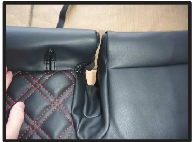
⑯シートベルトバックル部にカバーをかぶせます。
