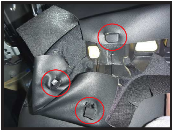
⑧サイドパーツの裏側には複数のツメがあり、シート本体の生地を固定しています。カバーにも同じ位置に切り込みが入っていますので、同様にツメに引っ掛け固定します。
