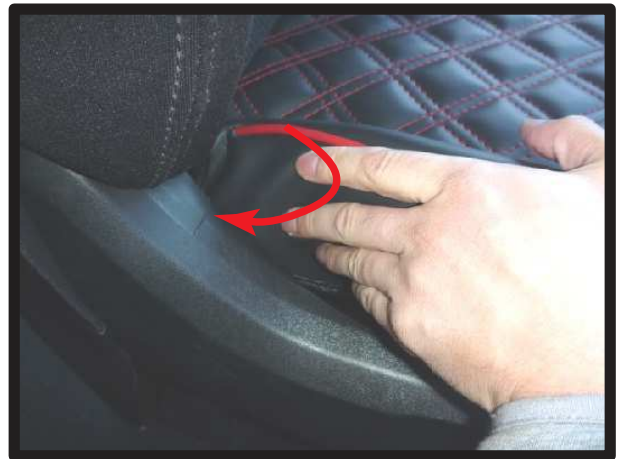
⑩背もたれ付け根付近の生地は、シートを巻き込むように入れ込みます。
