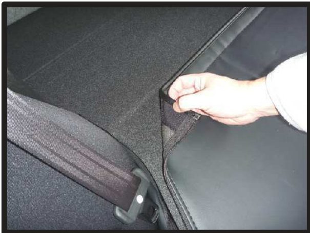
⑭カバー背面の生地は、マジックテープで直接シート背面に固定します。
