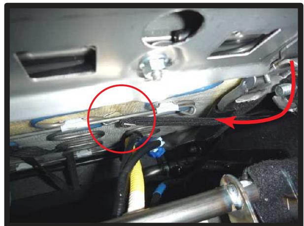
⑫S字フックを取り付けたゴムは、シートの内側面から底面に引き出し、シート下の金属部分に引っ掛け固定します。
