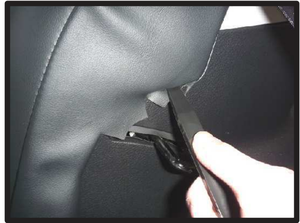
⑩サイドパーツを車体に戻し、はみ出している生地をヘラ等を使用し、車体の隙間に入れ込みます。
