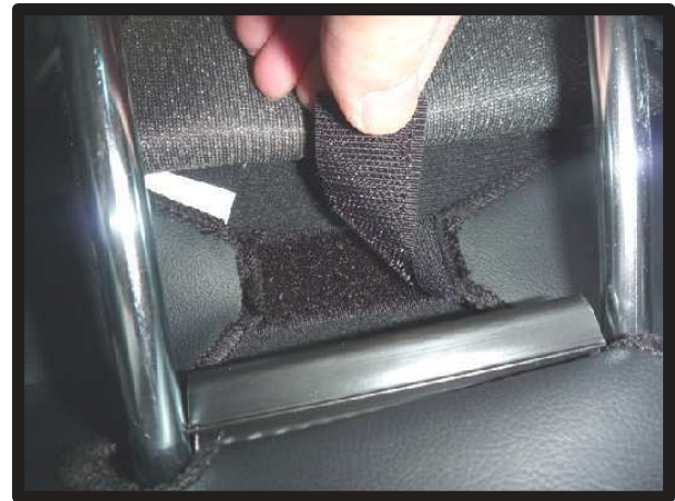
⑪ ヘッドレストを台座から取り外し、底面のマジックテープを固定した後、プラフックで固定します。 ※固定方法は巻末のプラフックの固定を参照します。
