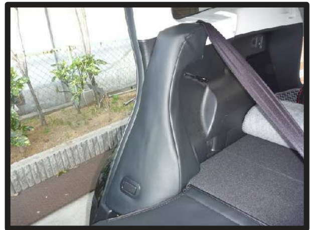
⑫カバーのラインを整え、15ページ①②で取り外したスイッチを元に戻し、運転席側サイドパーツの完成です。助手席側も同様に取り付けます。
