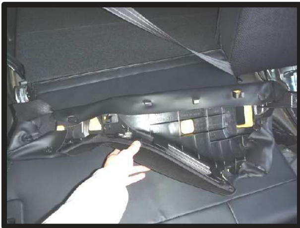
⑨カバーはこのように固定されます。ツメの無い位置の生地は、サイドパーツを戻す際に、車体の隙間に入れ込むようにします。
