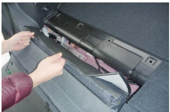
15 入れ込んだ生地を背面側から引き出します。カバーに切れ込みがあるので、その切れ込みでシートヒーターの配線をかわしながら引き出します。
