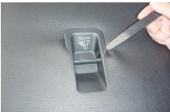
**20** シート背面のチャイルドシート固定用アンカー周りの生地を、ヘラ等を使用してシートとアンカーの隙間へ入れ込みます。
