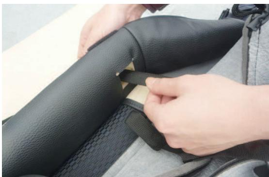
8 カバーに付いているベルトをシートのチャイルドシート固定用の加工穴に通します。
