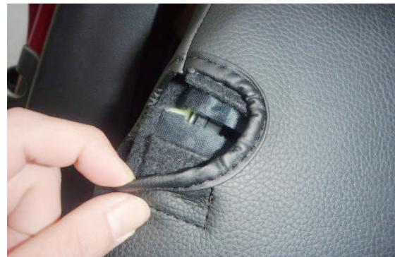
**22** シート背面の外側にある図の部分をカバーの加工穴を合わせ、カバーに付いているマジックテープをシートに直接固定します。
