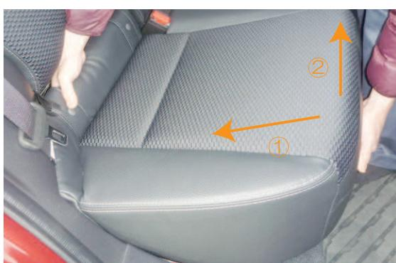
3 矢印①の方向へシートを押しながら矢印②の方向へシートを持ち上げます。
