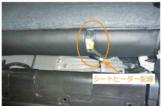
18 プラフックを固定すると図のようになります。シートヒーターの配線をかわしながらプラフックの固定を行って下さい。
