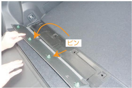
13 背もたれを前側に倒し、シートとラゲッジを繋いでいる生地の固定を外します。生地は図のようなピンで固定されていますので生地を持ち上げるようにしてピンをラゲッジから外します。
