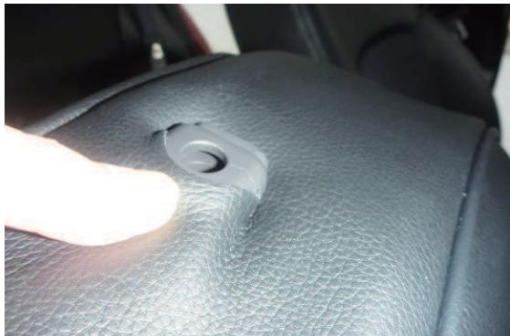
2 ヘッドレストの台座を生地の伸びを利用してカバーの加工穴から取り出します。
