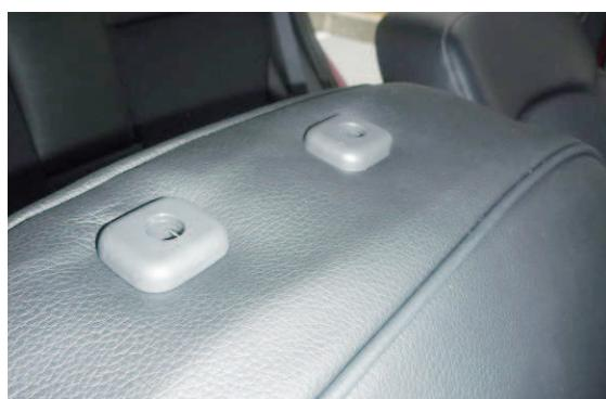
3 ヘッドレストの台座をカバーの加工穴から取り出した図です。
