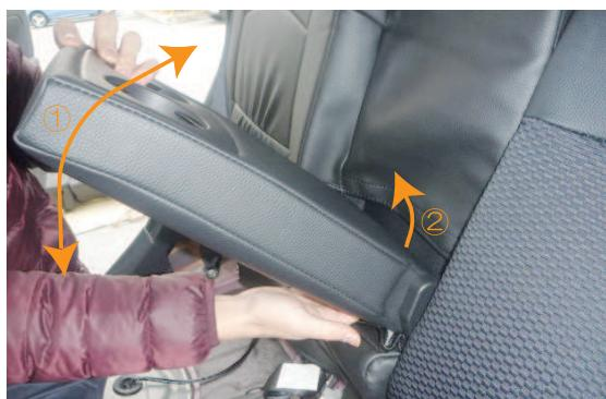
11 アームレストを矢印①の方向へ繰り返し動かしながら入れ込んだ生地を矢印②の方向へ引き出します。
