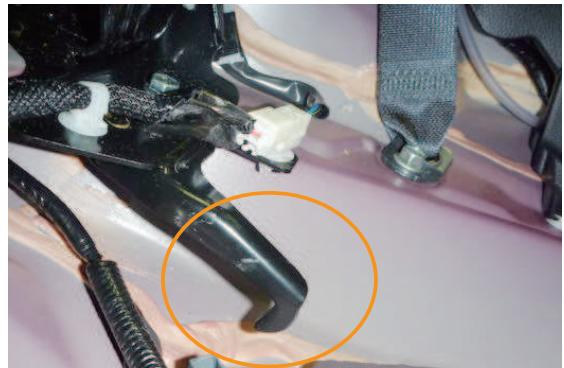
4 3番で押し込む金具は図の○部分に引っ掛けるように固定されています。
