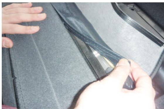
16 純正シートの生地がプラフックで背面側に固定されているので、図のように端から生地を取り外します。
