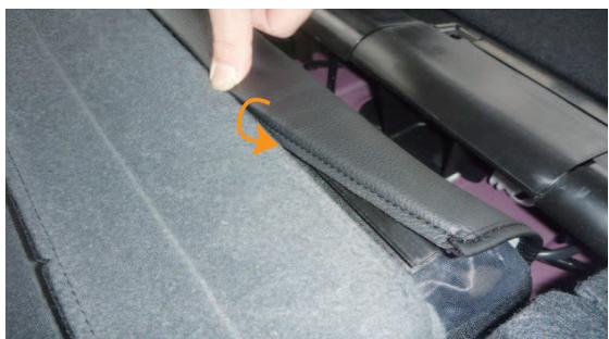
17 15番で引き出した生地に付いている板状のプラスチックを純正シート側のプラフックに生地ごと巻き込むようにして固定します。16番で取り外した生地はカバーの中に入れ込んでおきます。
