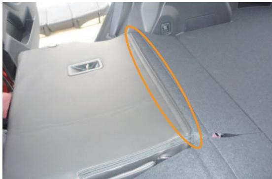
**19** カバー背面下に付いているマジックテープをシートに直接固定します。
