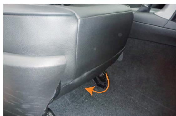
11 S字フックを取り付けた10番のゴムをシート底面裏の金属部分に固定します。
