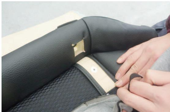
7 シートのチャイルドシート固定用の加工穴を覆っている生地を外します。
