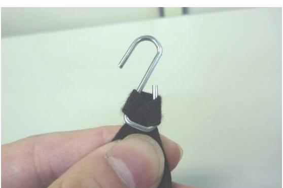
3 かぶせたゴムを引き絞る事で、図のようにS字フックがゴムに固定され、外れにくくなります。
