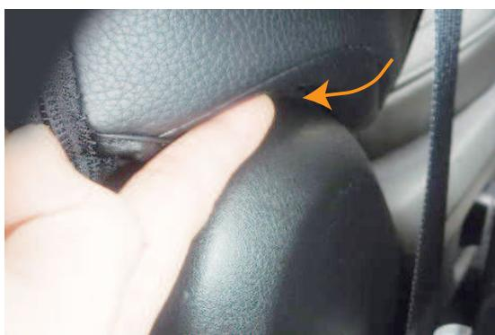
9 カバー外側面下の生地をシートの隙間にに入れ込みます。
