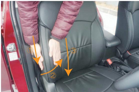
8 ①～③の手順で側面のシワを中央に寄せ、そのまま下になぞるようにシート側面のシワが無くなるまでカバーをシートに馴染ませます。馴染んできたところで7番のマジックテープを再度固定し直すと、よりきれいに装着できます。
