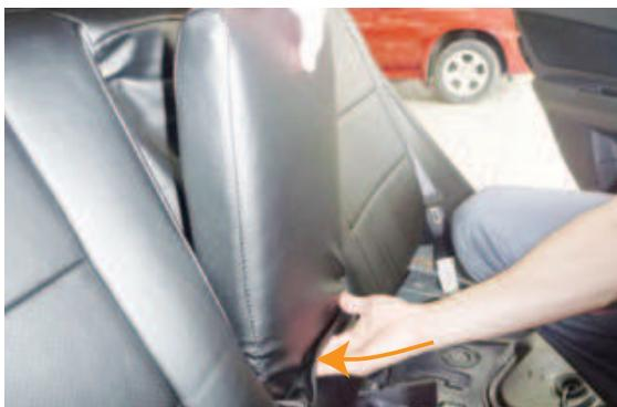
3 フック状のプラスチックが付いている生地をアームレストとシートの隙間に入れ込みます。
