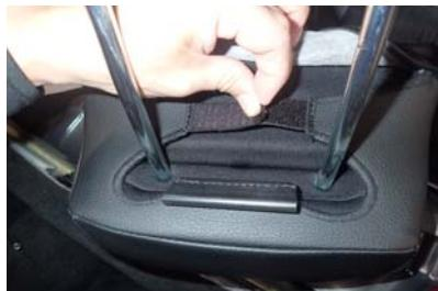
3 ヘッドレストの底面のマジックテープを留め合わせて固定します。
