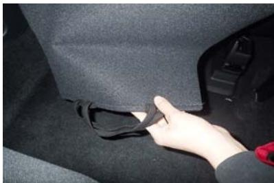
1 シート背面を覆っているシート表皮をめくります。シート底面に図のようにゴムで固定されているので、そのゴムを外します。
