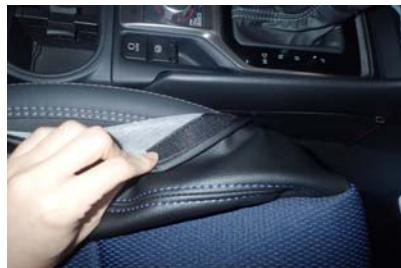
8 内側面の生地の前側にはマジックテープが付いています。シートに直接貼り付けて固定します。
