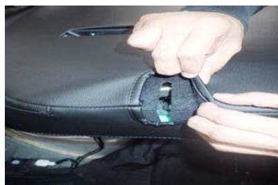
14 シート背面の穴にカバーの加工穴を合わせます。カバーの裏にはマジックテープが付いているので、直接シートに張り付けて固定します。
