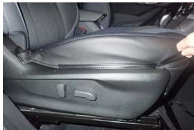
7 カバー外側面の固定用部材をヘラ等を使用して、シートのプラスチック部分へ入れ込みます。
