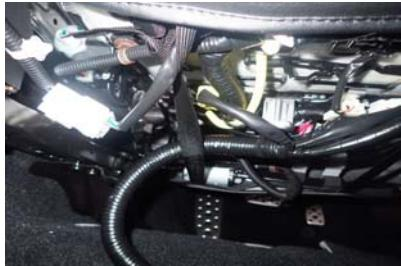
10 金属フックをゴムが届く範囲で、シート底面の金属部分に引っ掛けで固定します。
