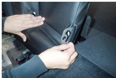
13 アームレスト固定用の金属をカバーの加工穴から取り出します。
