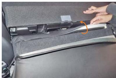
16 シートを前側に倒して、純正表皮の固定を取り外します。シート背面にプラスチックで固定されている部分があります。図のようにプラスチックのフックに、生地を巻き込んで固定されているので、端から剥がすように取り外します。※この作業を行わないで、背もたれのカバーが固定出来ないので、必ず行って下さい。
