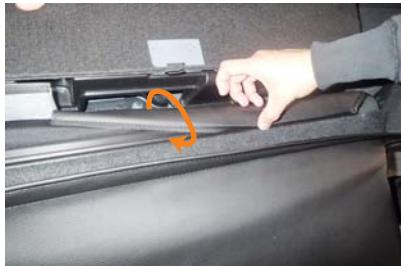
19 16P 16番で外した純正表皮をカバーの内へ入れ込みながら、カバーに付いている平らなプラスチックを、純正のプラスチックのフックに巻き込むようにはめて、固定します。（純正と同じ固定方法です）詳しい固定方法は18Pをご覧下さい。
