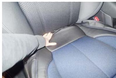
5 カバー後部の生地を座面と背もたれの隙間に入れ込みます。背もたれの角度を調節して、入れ込みやすい角度で行って下さい。
