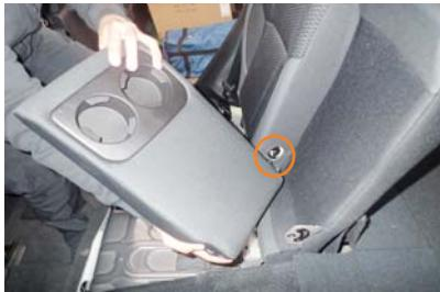
7 アームレスト内側の固定を外します。アームレストの軸を背もたれの穴から取り外します。
