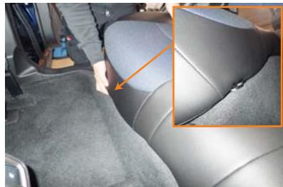
22 シート手前側のフックを、車体にはめ込みます。カバーの厚みで少しフックが戻しにくくなりますが、真上からしっかりと押し込むと固定されます。
