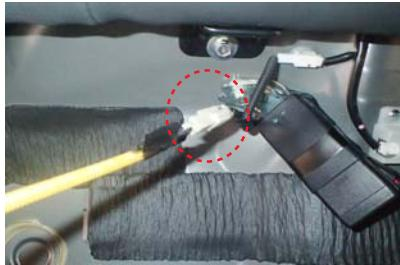
7 次にシートベルトの根元にあるカブラーを取り外します。運転席側、助手席側の合計2カ所を取り外して下さい。
