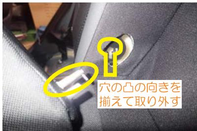
8 図のように軸を入れ込む穴は鍵形になっているので、アームレストを穴の形が合うように傾けて、取り外して下さい。
