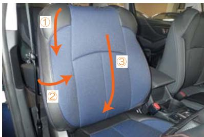
6 図の①～③の手順でカバーをシートに馴染ませます。①シートラインに沿わせるように生地を流します。②余った生地を中心へ寄せます。③寄せた生地を下に流して4番と同様に背面から引き出します。
