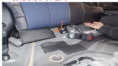
17 シートの隙間にカバー下部の生地を入れ込みます。配線をカバーの切れ込みで交わしながら、背面へ生地を回して下さい。
