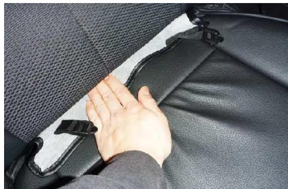
3 背もたれと座面の隙間に生地を入れ込みます。背もたれの角度を調整して入れ込みやすい角度で行って下さい。
