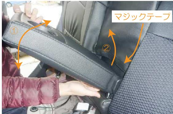
7 アームレストを矢印①の方向に動かしながらアームレスト収納部下の生地を入れ込みます。入れ込んだ生地を矢印②の方向へ引き出します。引き出した生地をマジックテープで固定します。
