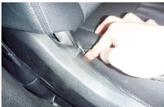
6 カバー外側面、背もたれとの付け根付近の生地も同様にしてプラスチックカバーの中へ入れ込みます。
