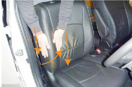
10 ①～③の手順で側面のシワを中央に寄せ、そのまま下になぞるようにシート側面のシワが無くなるまでカバーをシートに馴染ませます。
