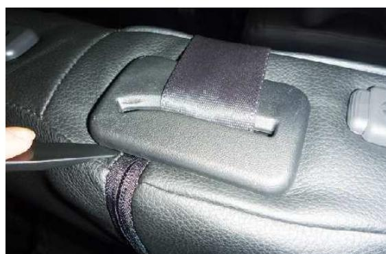
11 シートベルト周りの生地をシートとプラスチック部の隙間にに入れ込みます。
