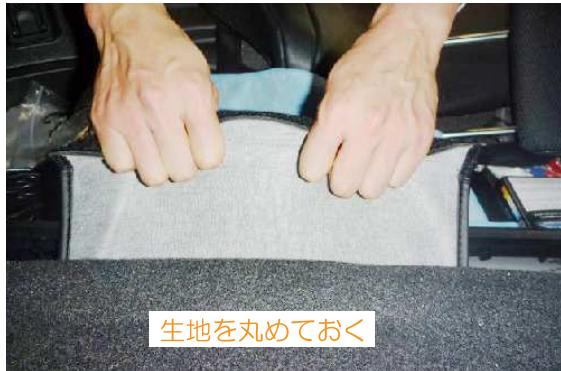
10 入れ込んだ生地をシートの背面側から引き出します。カバー背面のマジックテープと固定します。
