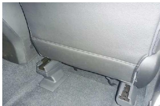
11 カバー背面下の生地についているゴムに付属のS字フックを結んで座面裏の金属部分に固定します。
