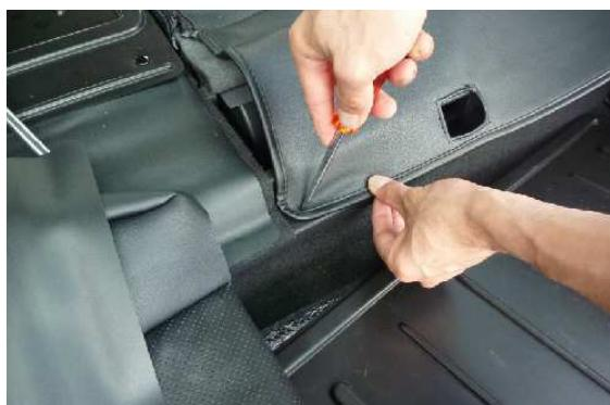
11 カバー背面下の生地をラゲッジのピンの位置に合わせて先端の尖った物でカバーに穴を開けます。(図ではきりを使用)
