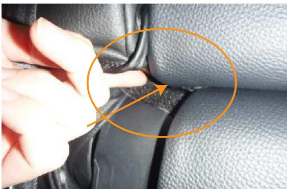
8 カバー中央部分に付いているマジックテープを図のようにシートの隙間から背面側へ通します。
