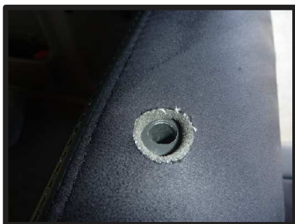
⑫ヘッドレストの台座をカバーの加工穴から取り出します。
