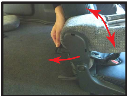
⑦アームレストを動かしながら生地を引き出すと作業がしやすくなります。
