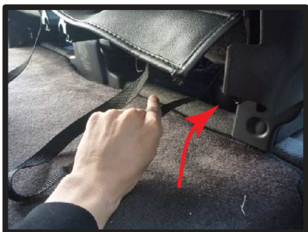
⑮ベルトを矢印の方向へ通していきます。
