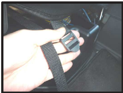
⑭引き出してきたベルトとカバー前方に付いているバックルを固定します。
