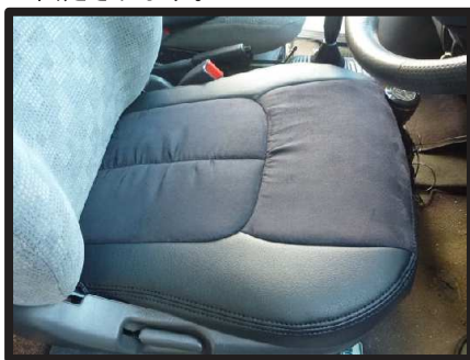
⑱ カバーのラインを整えて運転席側座面の完成です。助手席側も同様に取り付けます。
