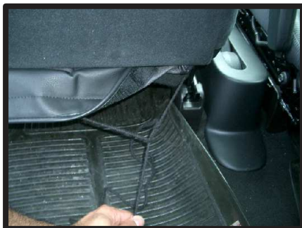
④背面に回り込んで、ヒモの片側に輪を作り、もう一方のヒモを輪に通して絞り込んでから結びます。 (※強く引きすぎると切れる恐れがあります。)
