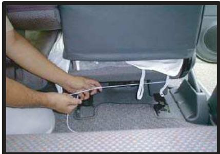
⑥シートを絞り込んだ状態で、ヒモを結びます。カバーに付いているゴムに付属のS字フックを取りつけ、座面底の適当な箇所に引っ掛けます。
