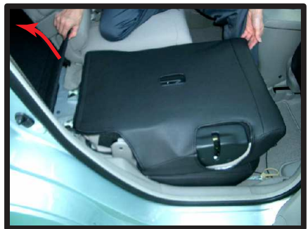
⑥背もたれを倒してトランクとのつなぎ板を起し、マジックテープを固定します。
