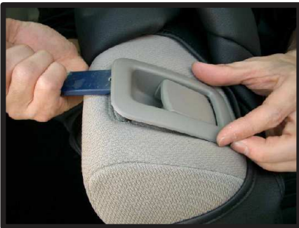
②リクライングレバーの隙間にヘラのようなものを差し込み、浮かせておきます。
