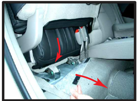
⑤座面を跳ね上げます。図の様にカーペットをめくり、背もたれ本体へマジックテープで固定します。
