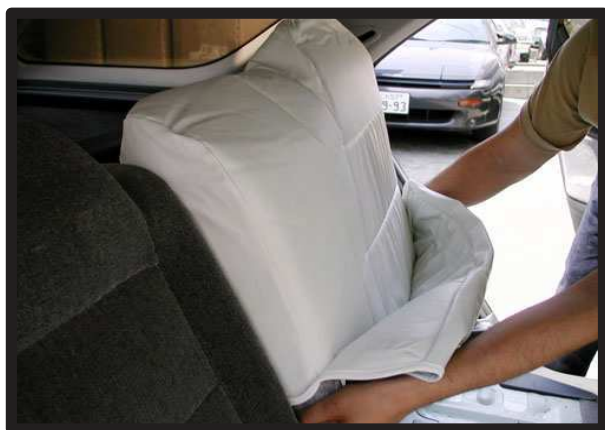
⑦純正のシートのラインに合わせて背面にカバーを被せます。
