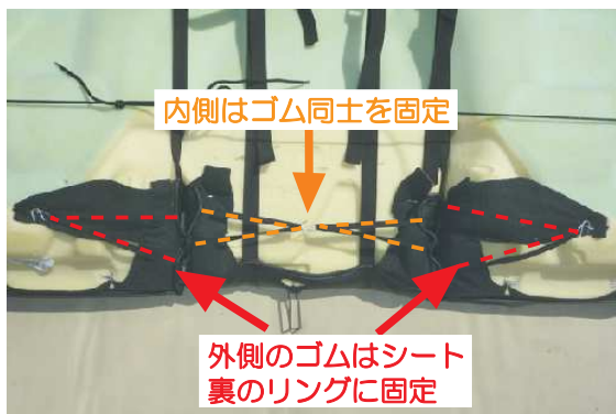
15 12ページ7番で入れ込んだ生地についているゴムに、S字フックを取り付けて固定します。内側のゴムはゴム同士をS字フックでつないで固定し、外側のゴムはS字フックをシート表皮を固定しているリングに引っ掛けて固定します。
