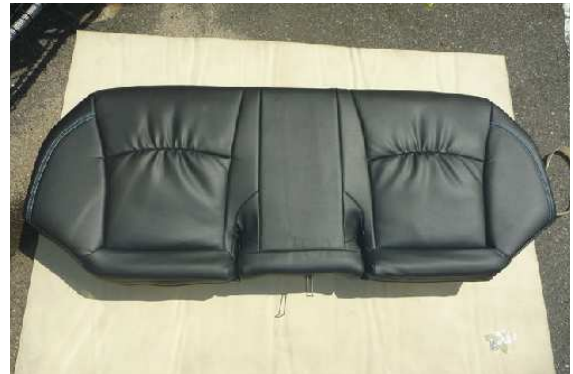
17 カバーのラインを整えて、2列目座面の完成です。 シートは2列目背もたれと、背もたれ横のパーツにカバーを取り付けてから、車体へ戻すようにします。
