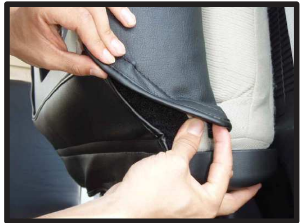
⑪⑧で引き出した生地と座面裏側へ回る生地をマジックテープで固定します。
