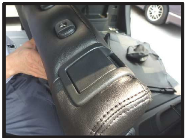
⑨リクライニングレバーを浮かせた状態で生地を入れ込みます。入れ込んだ生地を挟み込むようにリクライニングレバーをネジで固定し直します。
