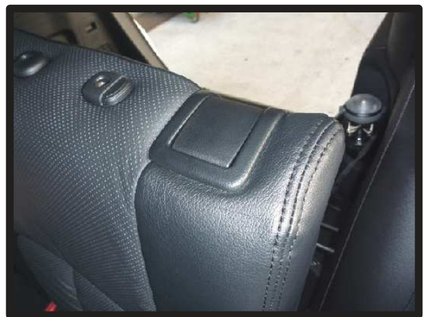
⑨リクライニングレバーを浮かせた状態で、隙間に生地を入れ込みます。入れ込んだ生地を挟み込むように、リクライニングレバーをネジで固定し直します。
