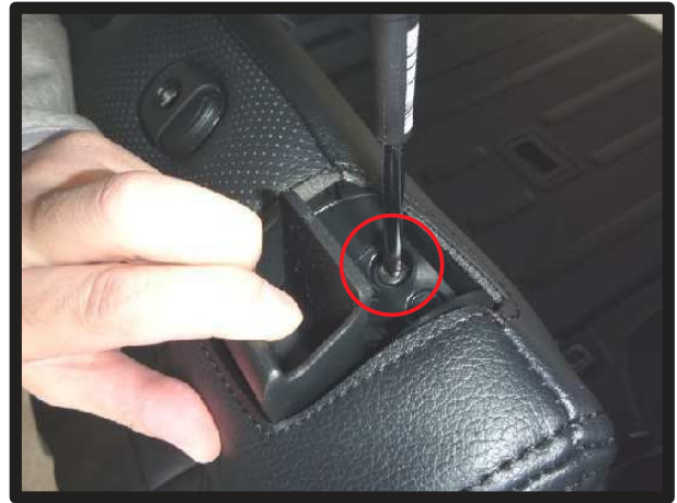
⑦リクライニングレバーを起こすと、中にネジが見えますので、+ドライバーを使用し外します。
