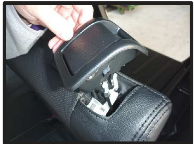
⑧ネジを外すと、リクライニングレバーをシートから浮かせることができます。
